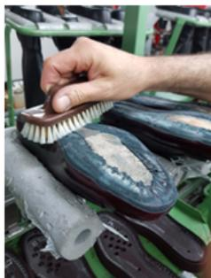
CONTROLLARE CHE LA TOMAIA MONTATA SU FORMA SIA STATA CARDATA CORRETTAMENTE RISPETTANDO LA SEGNAZIONE
