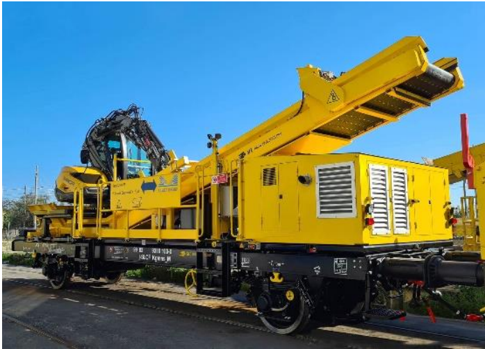
Figura 11: nastro di carico con escavatore
