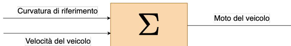
Figura 8.23.: Ciclo di controllo del servosterzo, vista esterna con ingressi ed uscite.
