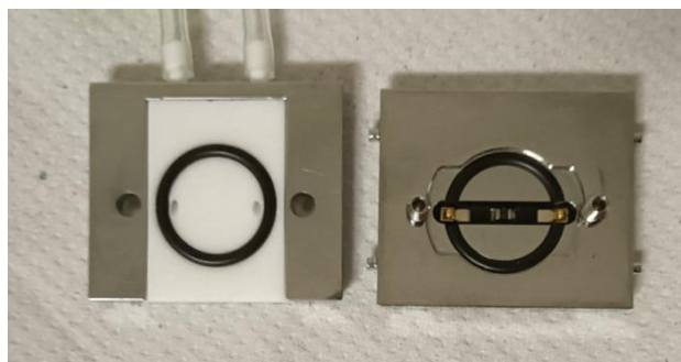
Figura 10 Struttura interna della camera di QCM-D in cui viene posto il sensore. A destra la componente in teflon con i fori di ingresso ed uscita per l'iniezione del campione ed a sinistra è possibile osservare parte del circuito elettrico su cui posano gli elettrodi del sensore per l'induzione del campo elettrico e la misurazione delle frequenze di oscillazione.
