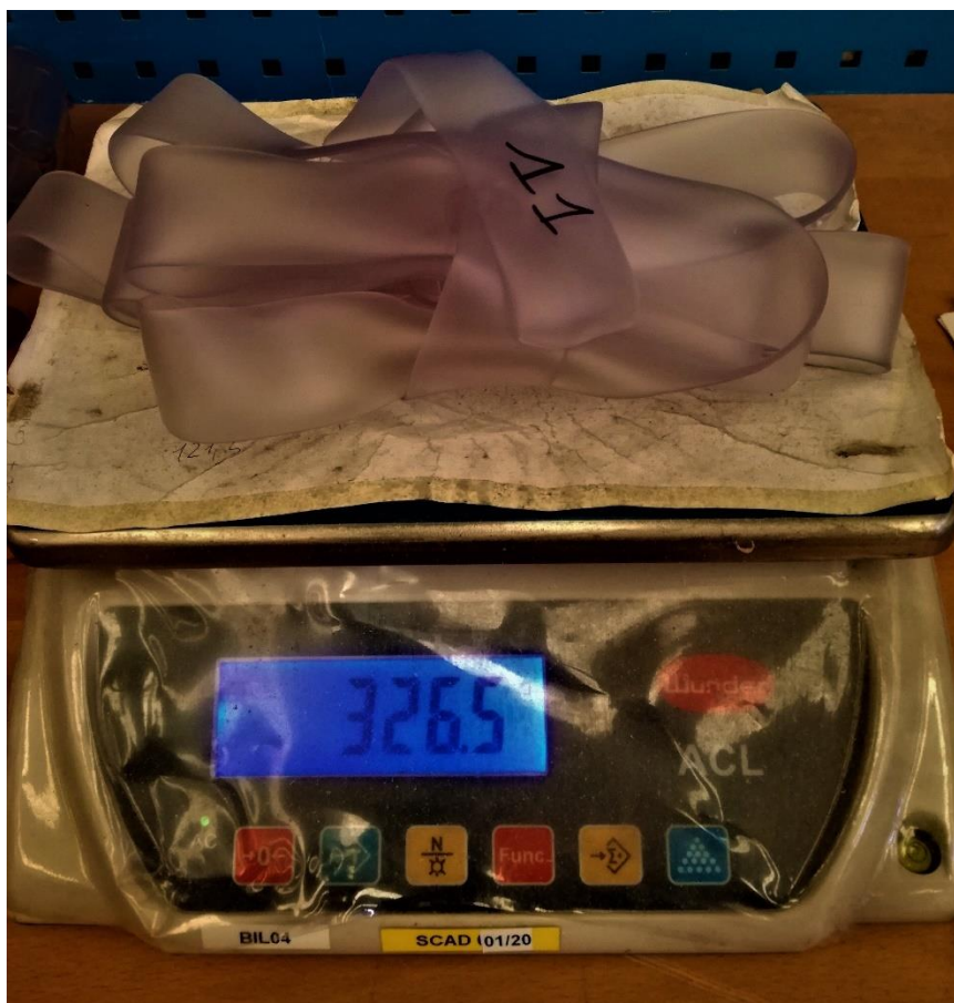
Fig.4.11 Pesatura del campione n°11 del compound PVC-11
