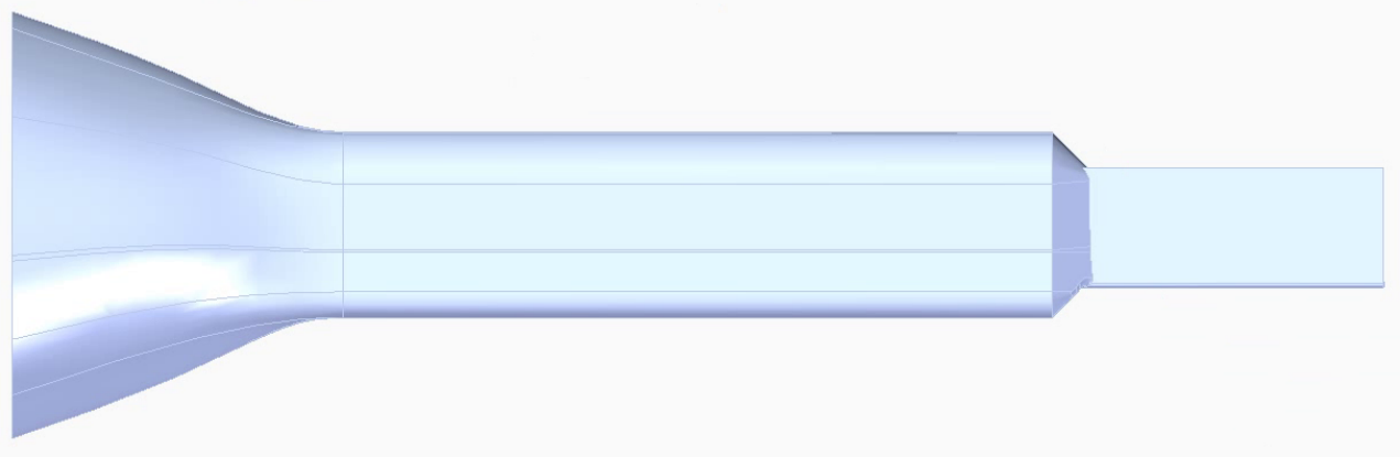
Fig.4.21 Vista laterale della modellazione CAD del canale della filiera in modalità ombreggiata
