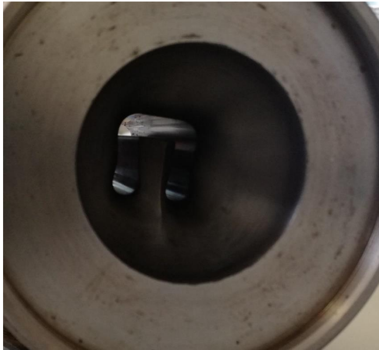
Fig.4.13 Tratto convergente conico a sezione circolare della filiera, visto dal lato in contatto con il sistema cilindro-vite dell'estrusore. Questa geometria è quella di raccordo tra queste due parti rispettivamente di formatura e plastificazione del polimero sottoposto a estrusione
