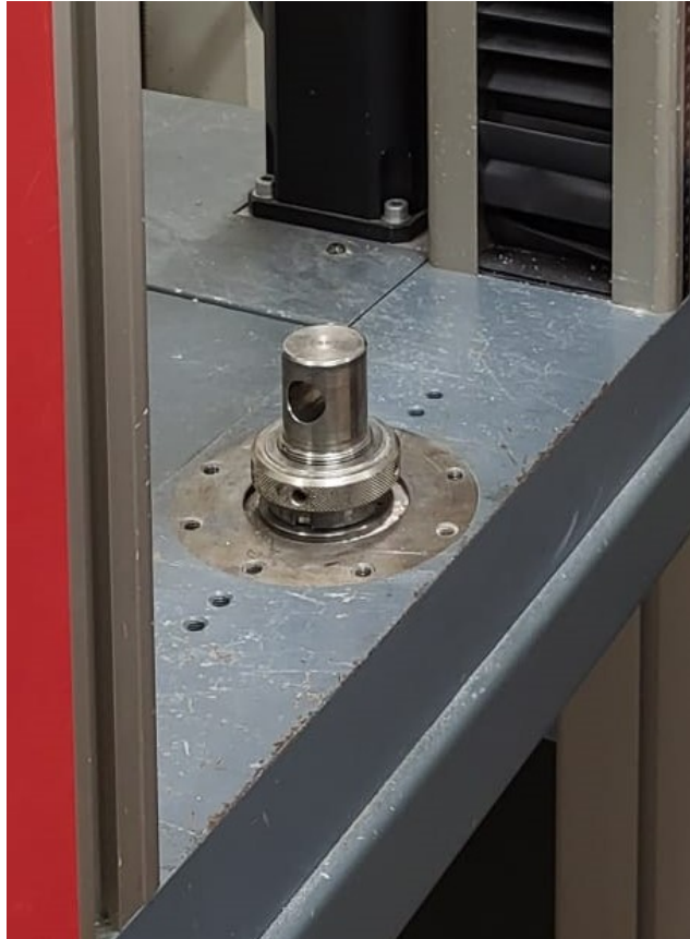
Figura 3.1: La figura mostra i 4 fori di fissaggio presenti sulla macchina di trazione
