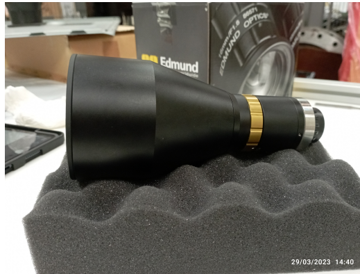
(a) Obiettivo telecentrico utilizzato per la misura di deformazioni
