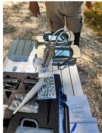
*Figura 11 - Strumenti per metodo diluizione salina*
