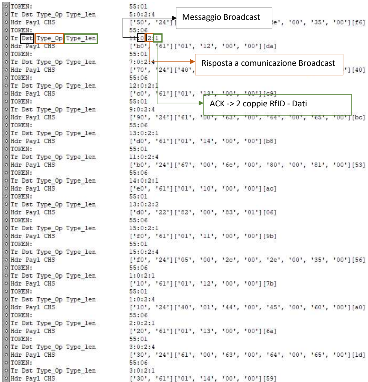
Figura 50 Schermata del software di debug. Fase di comunicazione tra main board con ID 01 e sensore Cooking Care con ID 06
