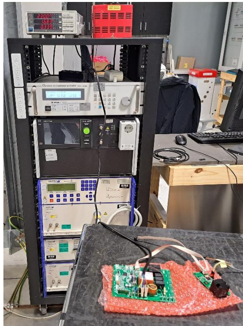
Figura 26 Assorbimento di potenza relativo al setup con multi-sensore Cooking Care connesso alla main board in standby mode
