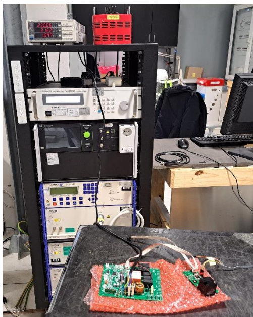
Figura 25 Assorbimento di potenza relativo al setup con multi-sensore Cooking Care connesso alla main board in running mode
