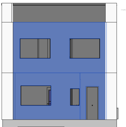
Figura 102: Individuazione delle aperture create sulla facciata Nord
