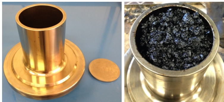
Figura 2.11 - A destra: fustella con coperchio da 100 mm impiegata nel lavoro sperimentale. A sinistra: fustella contenente il materiale miscelato da compattare per ottenere il provino.
