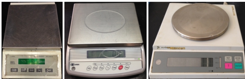
Figura 2.8 - Bilance da laboratorio impiegate nel lavoro sperimentale.
