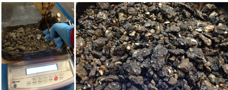
Figura 2.7 - Modalità di applicazione dell' additivo B eseguite nel lavoro sperimentale. Da sinistra: spruzzatura dell' additivo B sul RAP e risultato finale.
