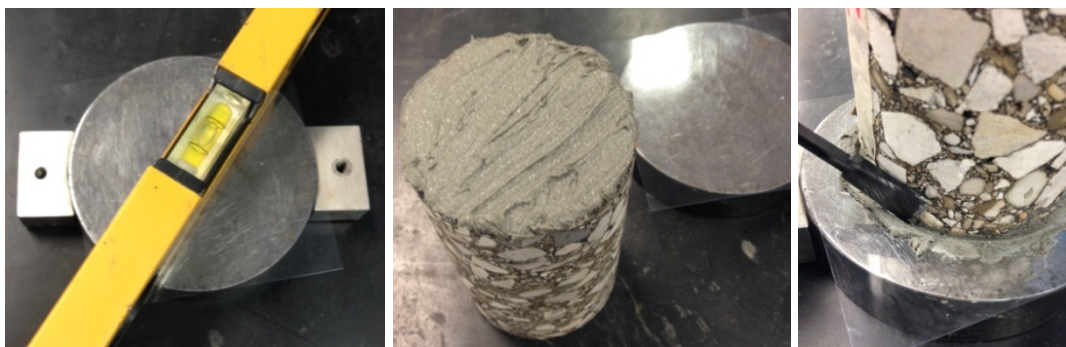
Figura 2.17 - Dettagli della procedura di spianamento di una faccia del provino ridimensionato eseguita nel lavoro sperimentale. Da sinistra: posizionamento della base metallica con superficie liscia perfettamente a livello, distribuzione della resina su una faccia del provino ridimensionato, rimozione della resina adiacente al perimetro della base del provino con l'ausilio di una spatolina.
