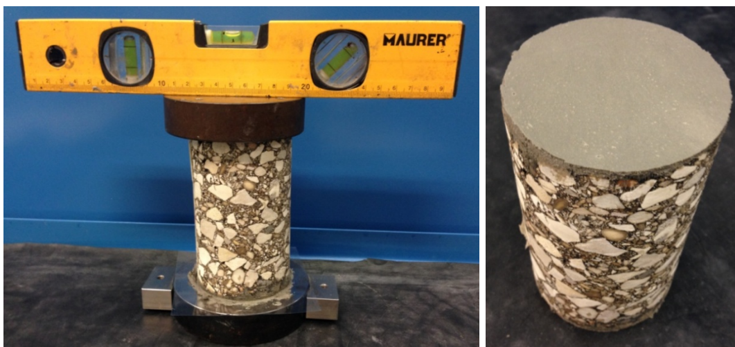
Figura 2.18 - Dettagli della procedura di spianamento di una faccia del provino ridimensionato eseguita nel lavoro sperimentale. Da sinistra: solidificazione della resina con base di carico in testa al provino e controllo livello, provino con base spianata a procedura ultimata.
