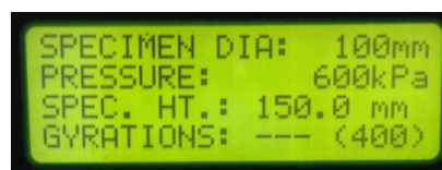
Figura 2.12 - Display della console comandi con i parametri di prova relativi al lavoro sperimentale.
