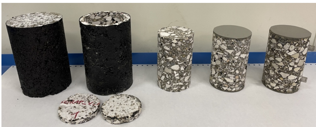
Figura 2.14 - Rappresentazione delle fasi, eseguite nel lavoro sperimentale, per preparare un provino compattato all'esecuzione della prova dinamica di modulo complesso. Da sinistra: provino compattato, ridimensionamento (fase I), spianatura delle basi con resina (fase IV) e posizionamento di 6 riscontri sul contorno (fase V).
