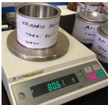
Figura 2.6 - Identificazione della tara delle lattine metalliche eseguita nel lavoro sperimentale.
