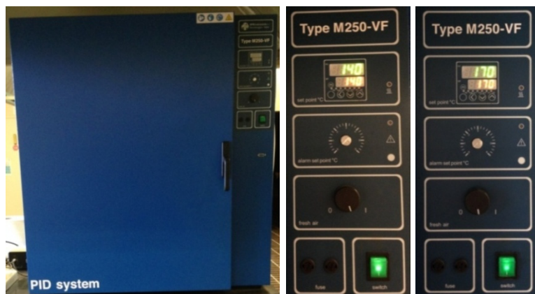
Figura 2.4 - Forno da laboratorio impiegato e relativi comandi con temperatura impostata rispettivamente a 140 °C e a 170 °C.
