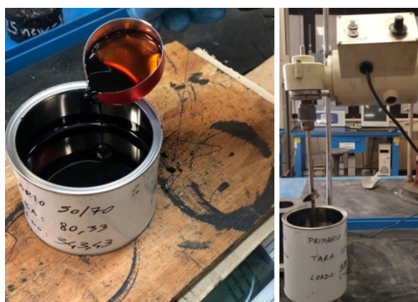
Figura 2.5 - Modalità di applicazione dell'additivo A eseguita nel lavoro sperimentale. Da sinistra: dosaggio additivo A direttamente nel bitume vergine e successiva miscelazione.
