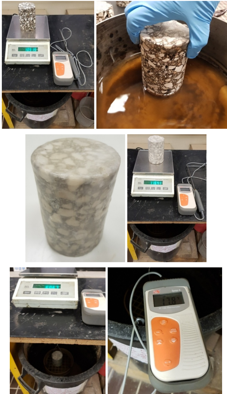
Figura 2.33 - Illustrazione delle fasi eseguite in ordine cronologico, nel lavoro sperimentale trattato, per determinare le caratteristiche volumetriche con il procedimento C detto procedimento con provino sigillato .
