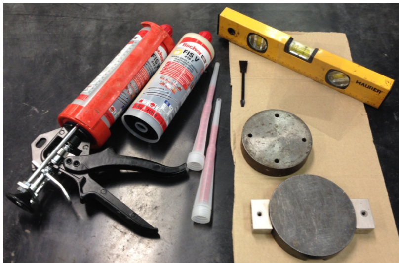
Figura 2.16 - Materiali impiegati nel lavoro sperimentale per la fase IV di spianatura delle basi del provino ridimensionato.
