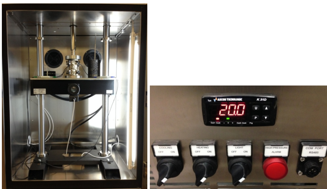
Figura 2.21 - Dettagli UTM-30. A sinistra: sistema traversa/pistone interno alla camera climatica; a destra: console comandi.
