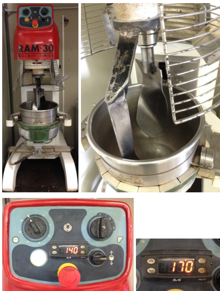
Figura 2.9 - Miscelatore meccanico impiegato nel lavoro sperimentale, pale e console comandi con display riportante la temperatura di miscelazione adottata nel lavoro sperimentale.
