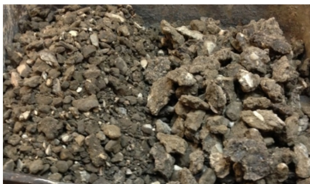
Figura 2.2 - Frazioni di RAP impiegate nel lavoro sperimentale. Da sinistra: RAP 0/8 e RAP 8/16.
