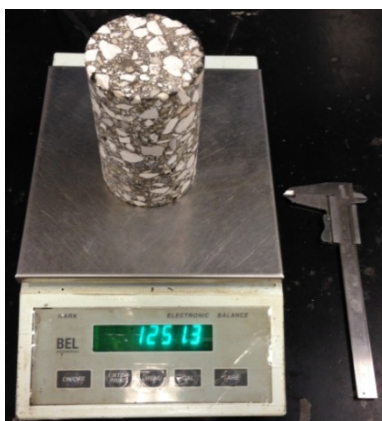
Figura 2.15 - Misurazioni sul provino ridimensionato. Bilancia da laboratorio e calibro manuale di tipo a corsoio a nonio semplice.
