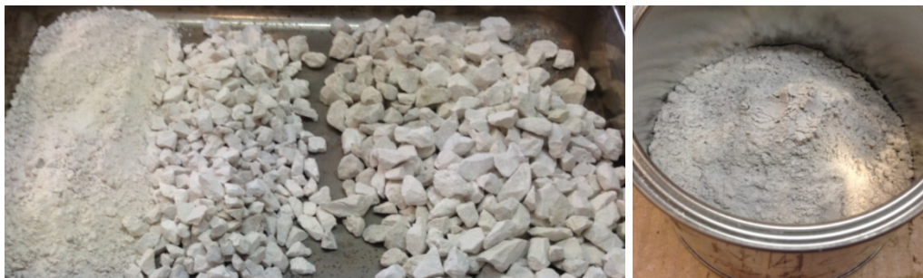
Figura 2.1 - Aggregati vergini impiegati nel lavoro sperimentale. Da sinistra: sabbia calcarea, aggregato grosso di calcare (6/12 e 12/16) e filler di recupero.
