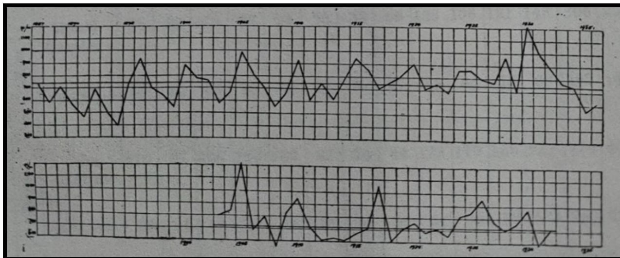
Fig. 1.19 – Diagramma delle precipitazioni annue del cinquantennio 1881 – 1936 dell'osservatorio di Pesaro e del trentennio 1903 – 1932 dell'osservatorio di Rimini (immagine ricavata dal manoscritto "Le spiagge marchigiane, a cura di U. Buli e M. Ortolani")
