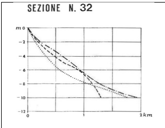
Fig. 2.29 – La sezione n. 32, eseguita presso la foce del Foglia, pone in evidenza una diminuzione della profondità dei fondali presso la costa dopo il 1870.
