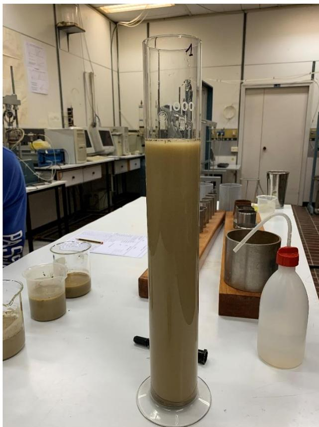
Figura 59. Cilindro di vetro portato a volume e pronto per entrare in vasca di sedimentazione.
