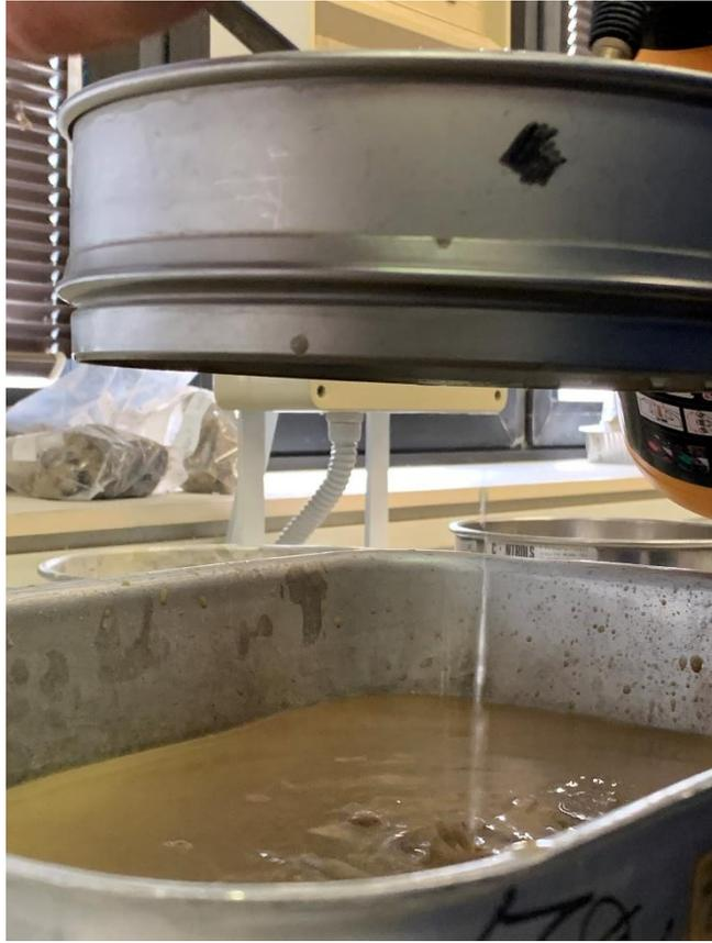
*Figura 38 Si verifica che l'acqua non trasporti più materiale e che quindi sia limpida per il termine della prova*
