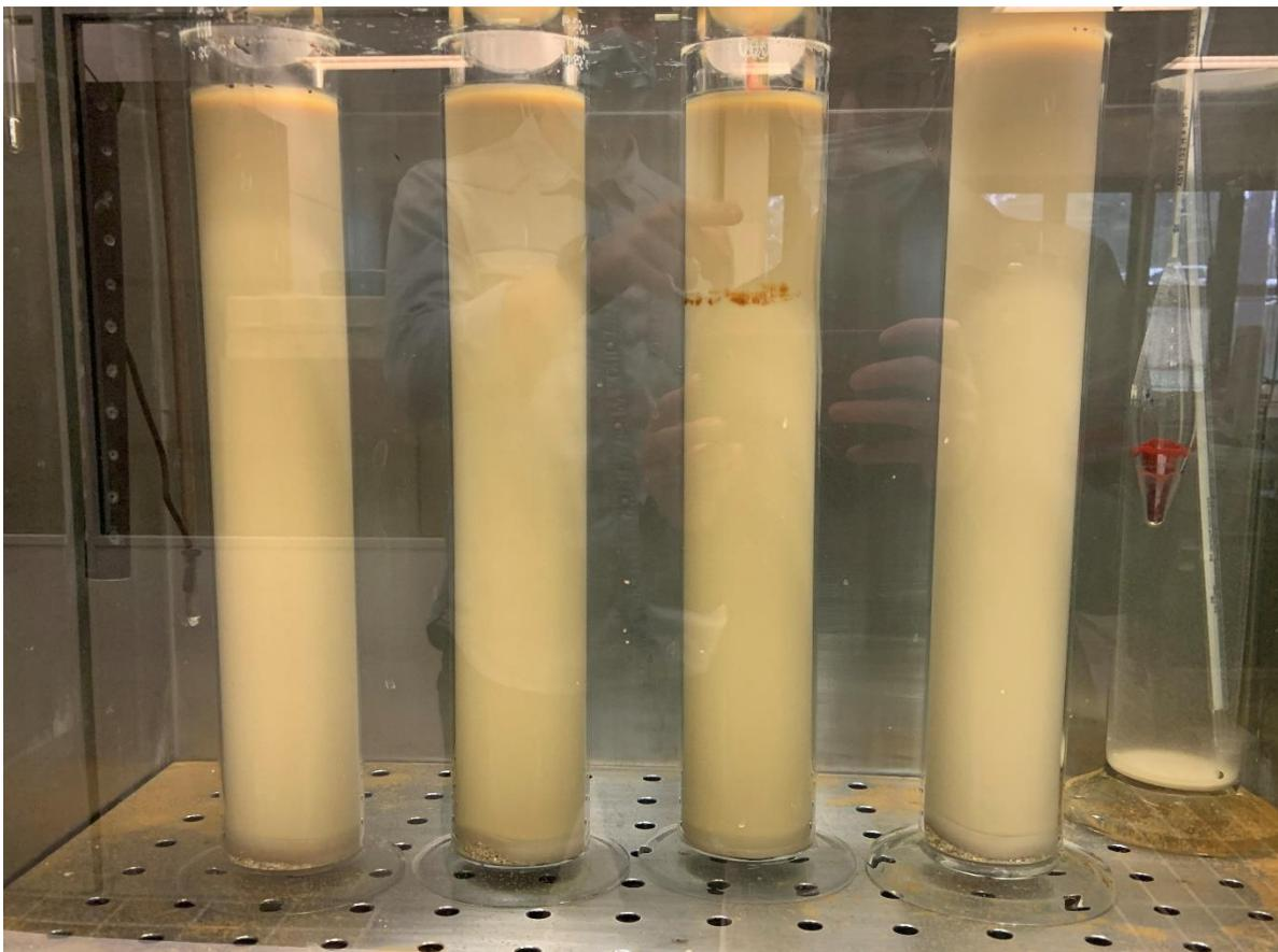
*Figura 60. Esecuzione della prova: i cilindri sono disposti nella vasca termostatica per la sedimentazione gravimetrica.*
