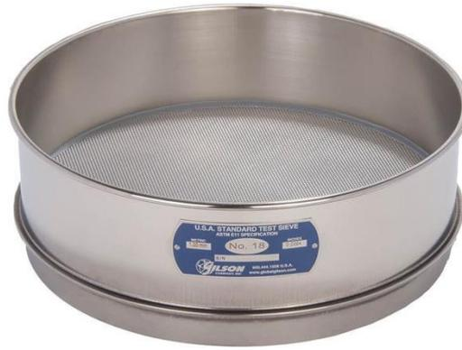
Figura 7. Esempio di setaccio (12" ASTM sieve) ([www.globalgilson.com](http://www.globalgilson.com))
