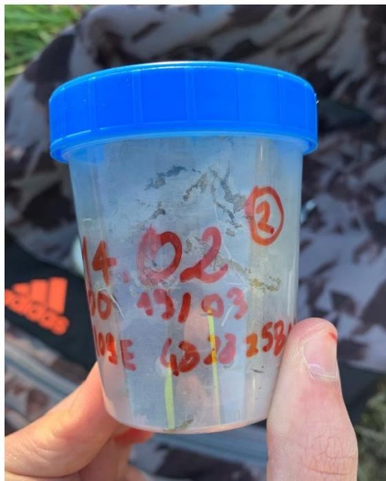
*Figura 32. Barattolo da sigillare contenente il campione su cui determinare il contenuto di acqua*
