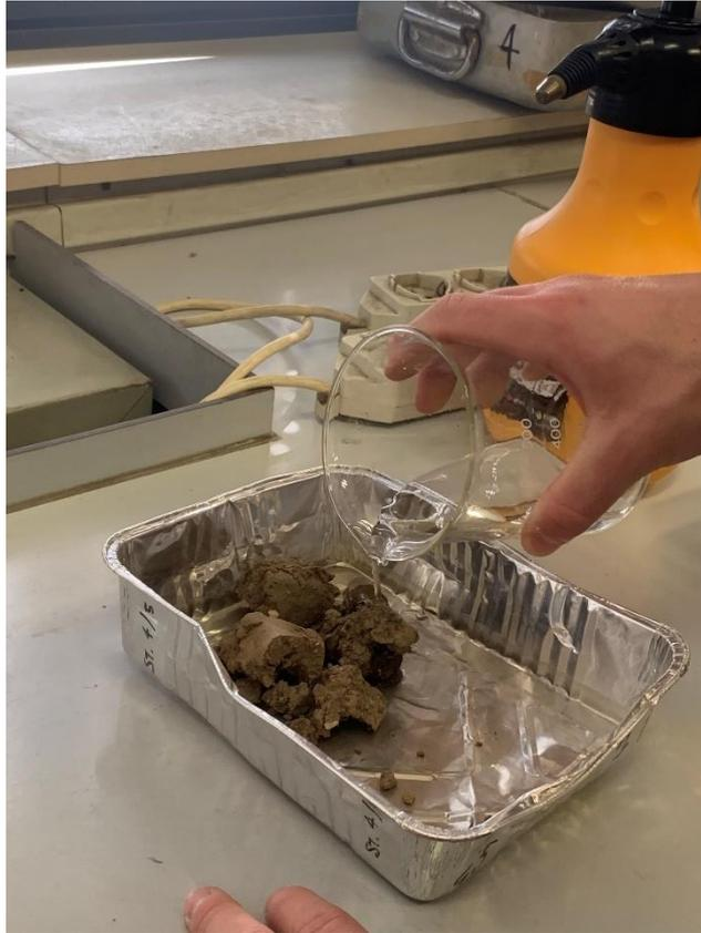
Figura 43. Aggiunta della soluzione disperdente sul provino essiccato
