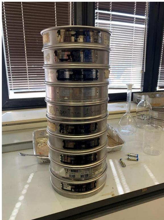
*Figura 6. Pila di setacci ASTM*
