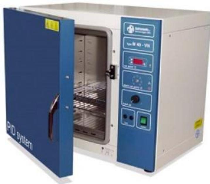
Figura 17. Stufa da laboratorio ([www.strumentidalaboratorio.com](http://www.strumentidalaboratorio.com))
