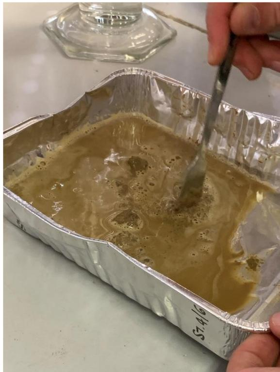
*Figura 45. Provino pronto per la vagliatura al setaccio n° 200 ASTM*
