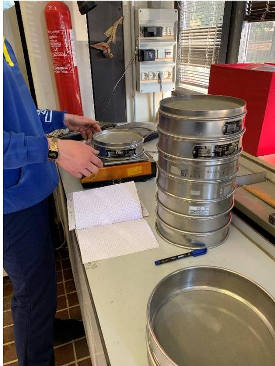
*Figura 39 Taratura dei setacci ASTM*
