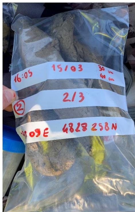
Figura 36. Provino 2/3 del sito 2 relativo a depositi alluvionali
