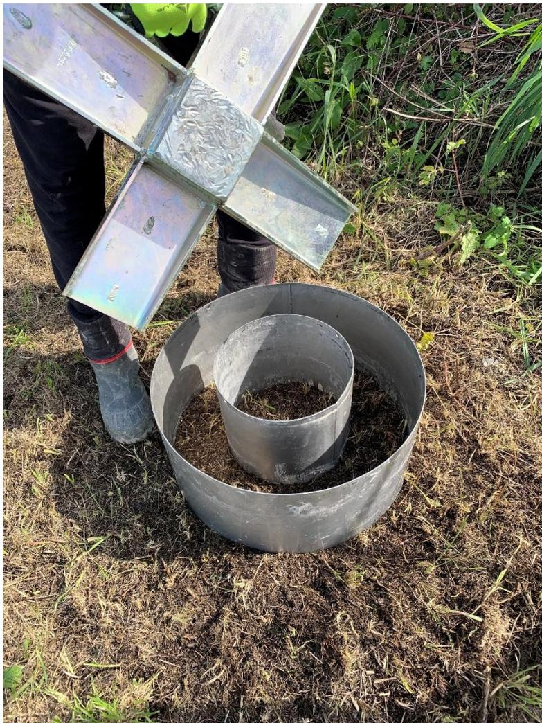
*Figura 28. I due anelli concentrici posizionati prima dell'infissione nel terreno e la piastra di carico.*
