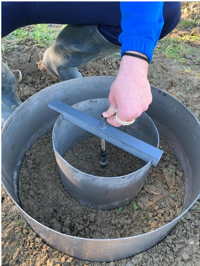
*Figura 30. Posizionamento dello strumento di misura prima dell'esecuzione della prova.*
