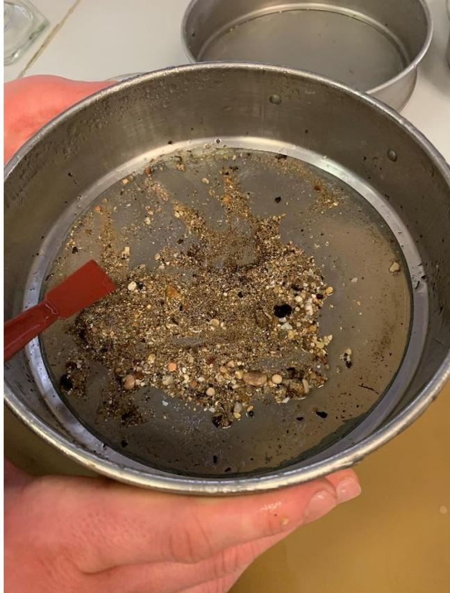
*Figura 50. Il trattenuto al setaccio n° 200 ASTM utile per la prova*
