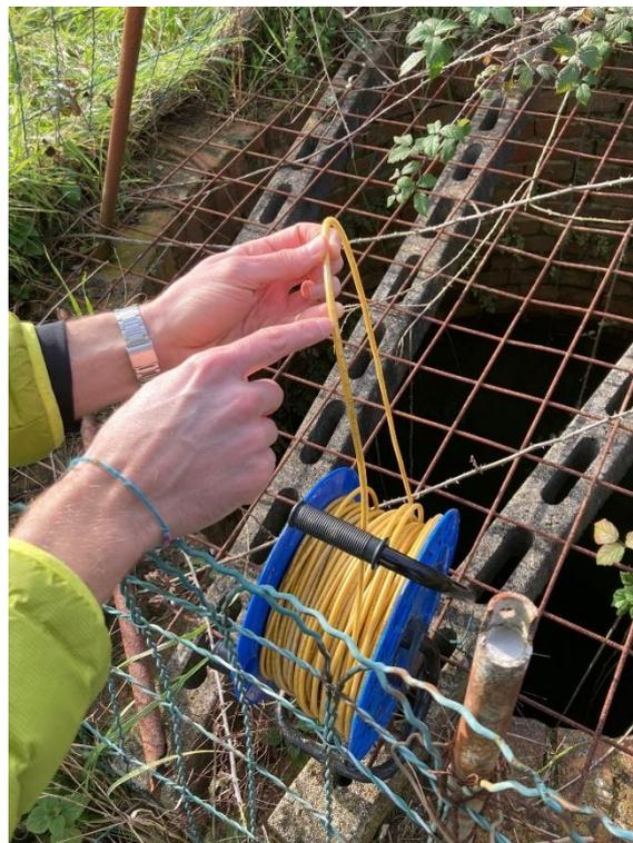
*Figura 25. Lettura del livello del pelo libero della falda attraverso il freatimetro.*
