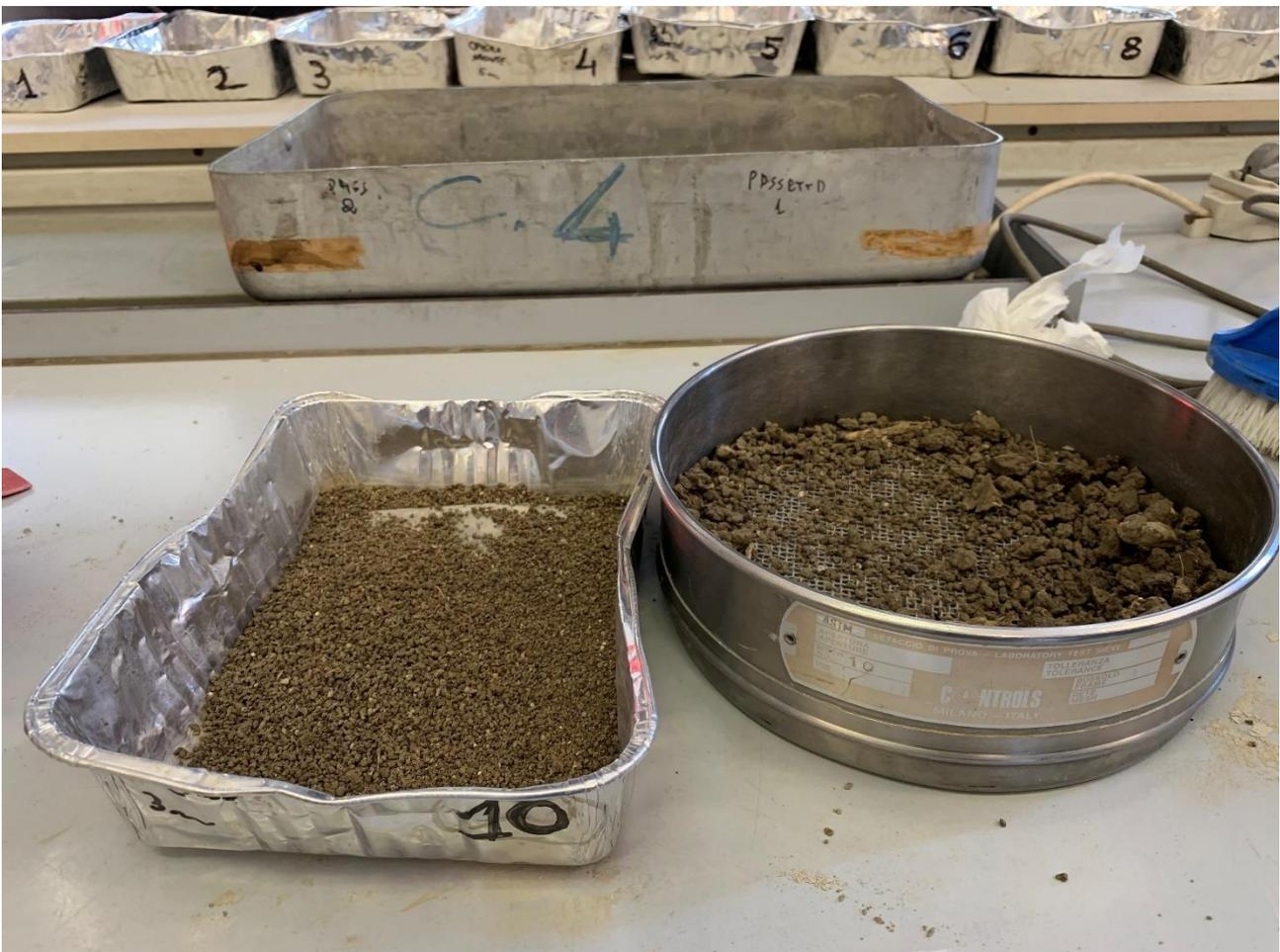
*Figura 56. A sinistra il recipiente di alluminio numerato con all'interno il passante al setaccio n° 10 ASTM, a destra il setaccio n° 10 ASTM con il trattenuto da scartare*
