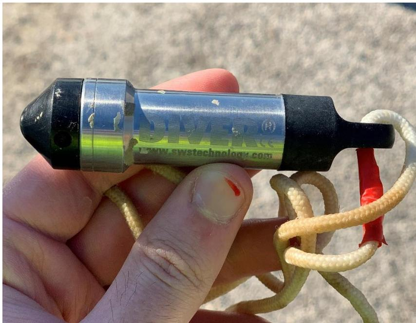
*Figura 16. Trasduttore di pressione "Diver"*
