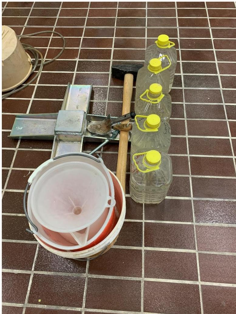
*Figura 27. Sono mostrate delle taniche contenenti acqua, la piastra di acciaio che distribuisce i carichi per l'infissione dei due anelli, una mazza, una paletta e dei secchi utili alla prova.*
