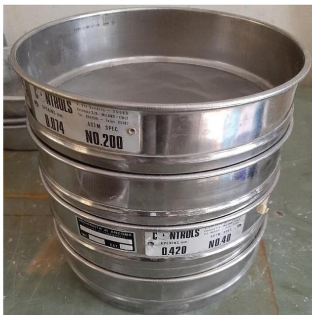
*Figura 41. Alcuni dei setacci ASTM utilizzati.*
