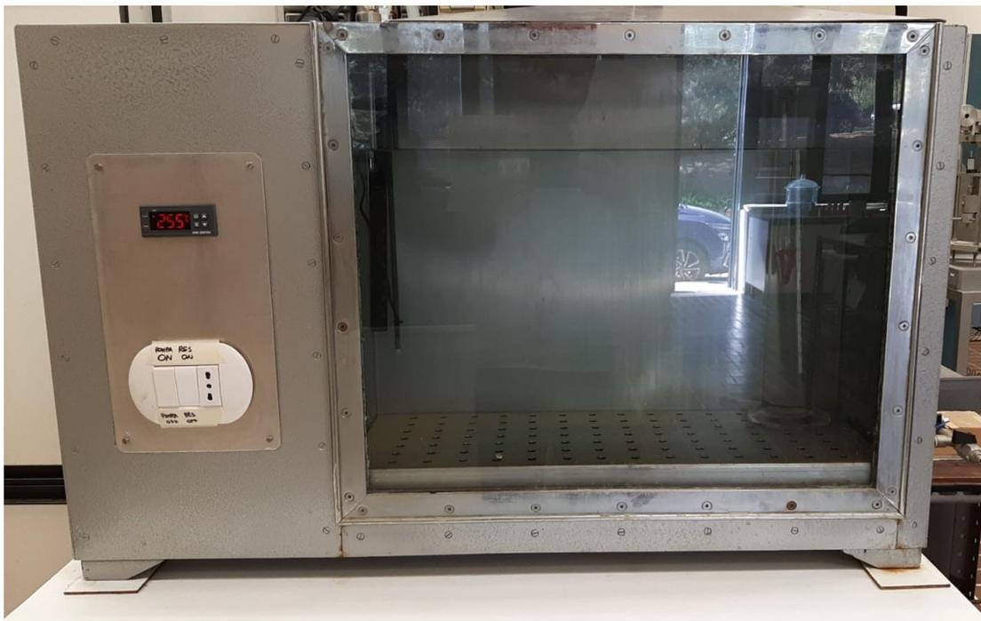
*Figura 18. Vasca termostatica per aerometrie*
