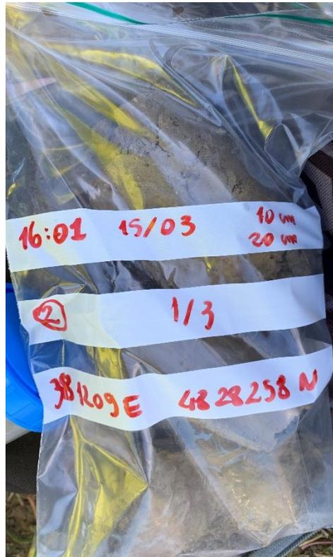
Figura 35. Provino 1/3 del sito 2 relativo a depositi alluvionali.
