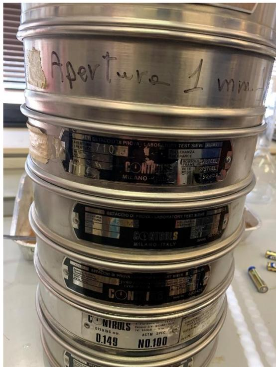
*Figura 53. Un particolare della pila dei setacci ASTM*
