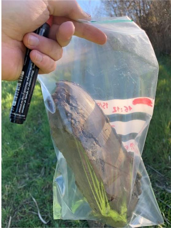
*Figura 33. Provino per le analisi granulometriche inserito nel sacchetto apposito*
