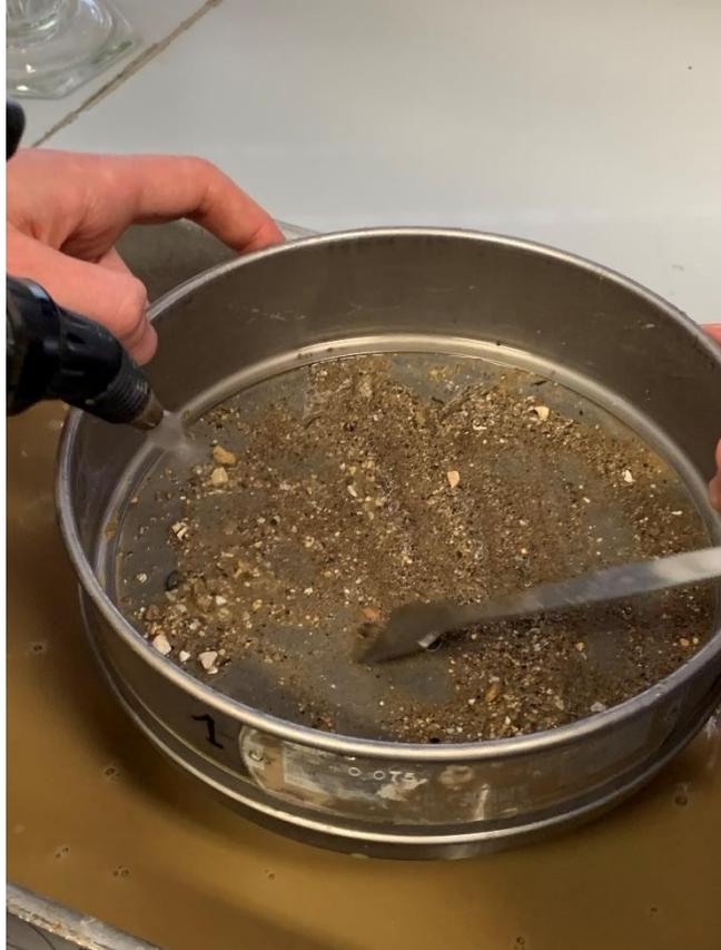
*Figura 48. Con l'ausilio di acqua distillata e delle spatole da laboratorio si effettua la vagliatura*
