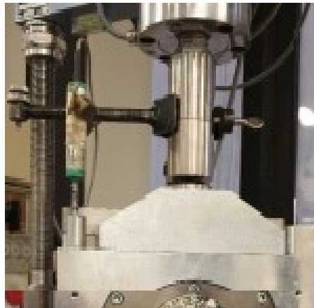
Figura 3.5. 1-10 Posizionamento del trasduttore
