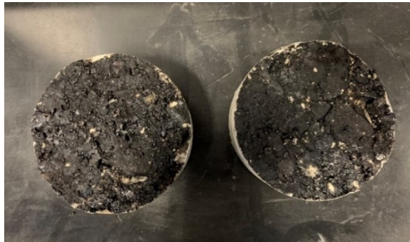
Figura 3.5.1-13 Particolare dell'interfaccia del provino
