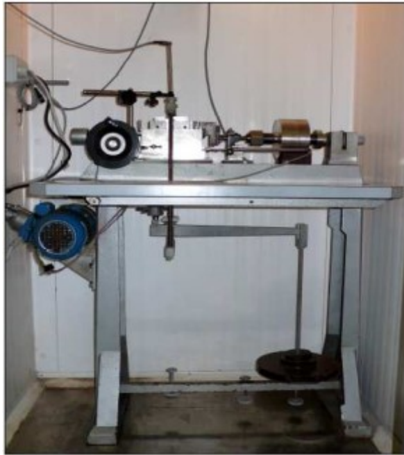
Figura 3.5.2-14 Apparecchiatura di prova in azione con carico verticale applicato
