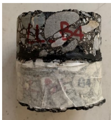
Figura 3.5.1-5 Applicazione del nastro adesivo in corrispondenza dell'interfaccia
