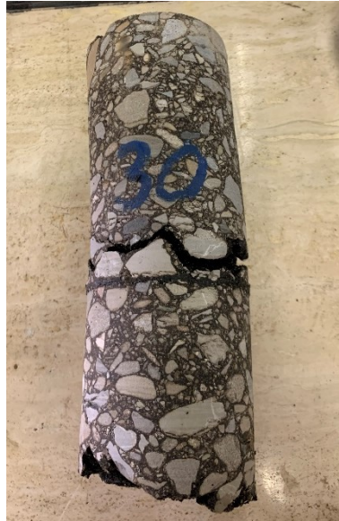
Figura 3.4-6 Carota rotta all'interfaccia
