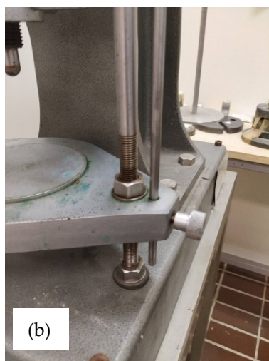
Figura 37 – Strumenti di regolazione edometro; (a) Livella del braccio-leva; (b) Viti di regolazione micrometro.
