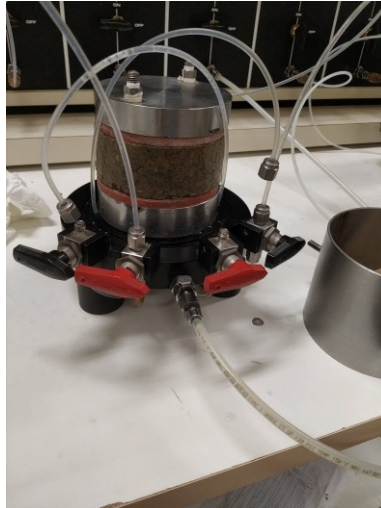
Figura 31 – Alloggiamento del campione all'interno della cella triassiale.
