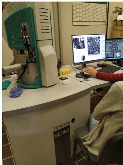
Figura 43 – SEM Tescan Vega3 LMU del dipartimento SIMAU dell'Università Politecnica delle Marche.
