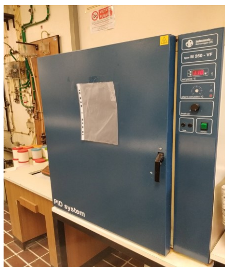
Figura 25 – Forno geotecnico termostatico per l'essiccazione dei campioni di terreno.
