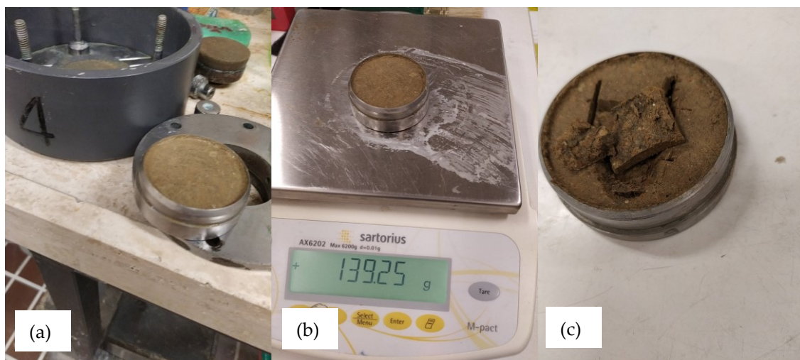
Figura 38 – Smontaggio della cella edometrica a fine prova; (a) Rimozione fustella; (b) Misura del peso lordo umido finale; (c) Prelievo materiale di scarto per controllo contenuto d'acqua w .
