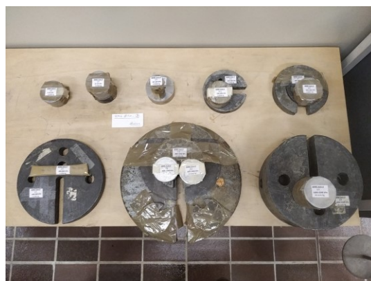
Figura 33 – Serie di carichi della prova di compressione edometrica.
