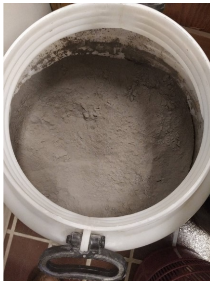
Figura 55 – Cenere volante Micro-Pozz PFA utilizzata per lo studio.
