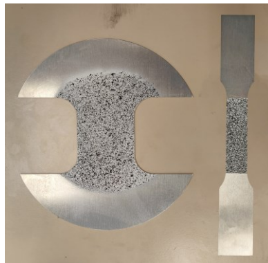
Figura 3.5: Speckle sulla superficie dei campioni D ed E.
