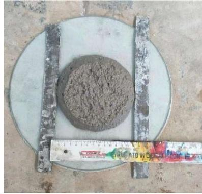
**Fig.4.4** – Misurazione dello spandimento della miscela 10% LS/55% SLAG.
