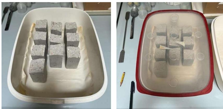
**Fig.4.37** - Provini sottoposti a prova di assorbimento secondo la UNI EN 15801:2010.
