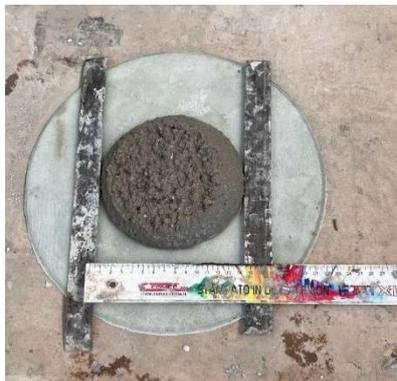
**Fig.4.7** – Misurazione dello spandimento della miscela 20% LS/45% SLAG.
