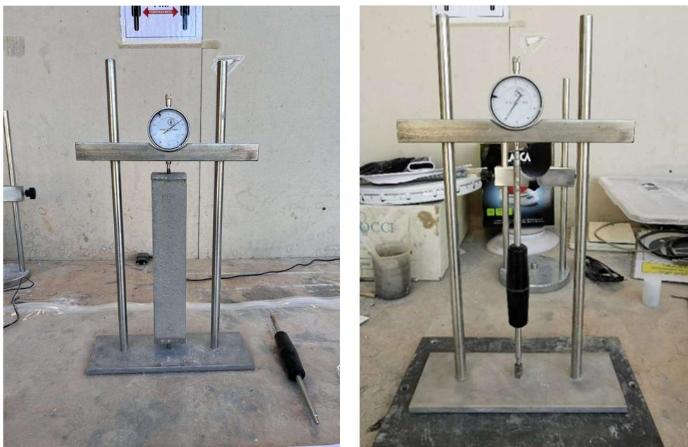
**Fig.4.33** – Micrometro per la rilevazione del ritiro vincolato del provino (a) e barra di calibrazione (b).
