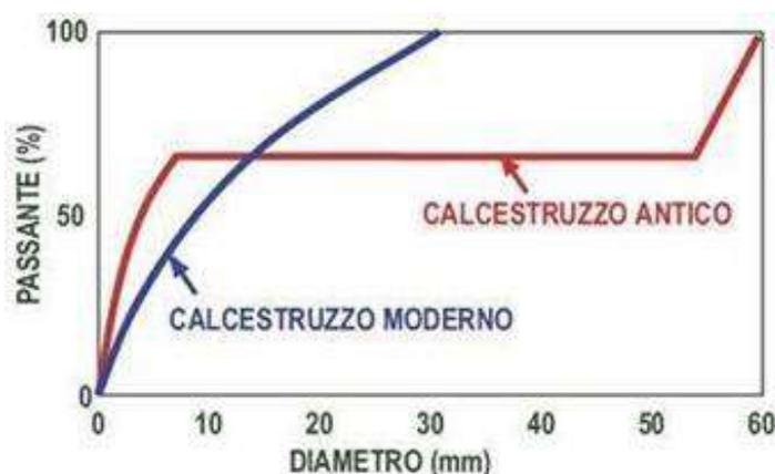
Fig.2.1 -Differenza granulometrica dell'aggregato fra il calcestruzzo antico e moderno.
