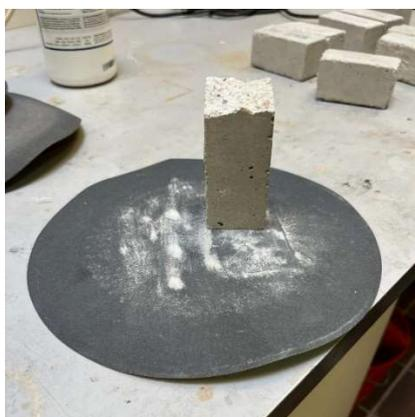
**Fig. 4.36** – Levigazione della faccia del provino con carta abrasiva.
