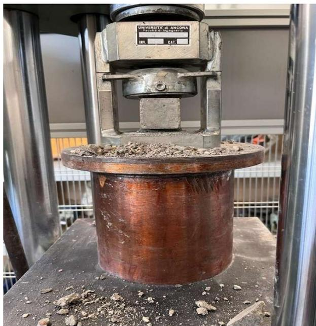
**Fig. 4.23** – Apparecchiatura per rottura a compressione.
