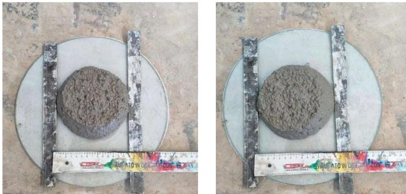
**Fig.4.4** – Misurazione dello spandimento della miscela RIF.
