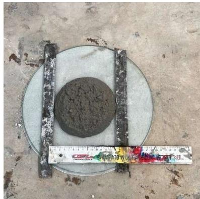
**Fig.4.6** – Misurazione dello spandimento della miscela 30% LS/35% SLAG.
