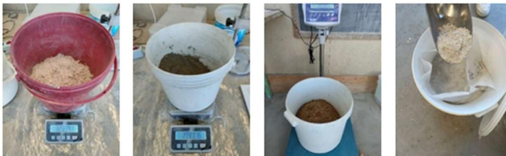
Fig. 3.1 – componenti delle malte: sabbia Esincalce, filler calcareo, cemento, loppa d'altoforno.
