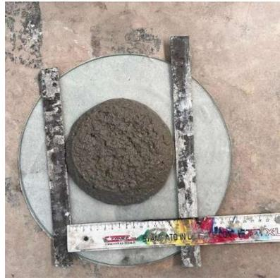
**Fig.4.5** – Misurazione dello spandimento della miscela 20% LS/45% SLAG.
