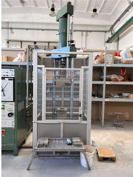
**Fig.4.16** – Pressa idraulica.
