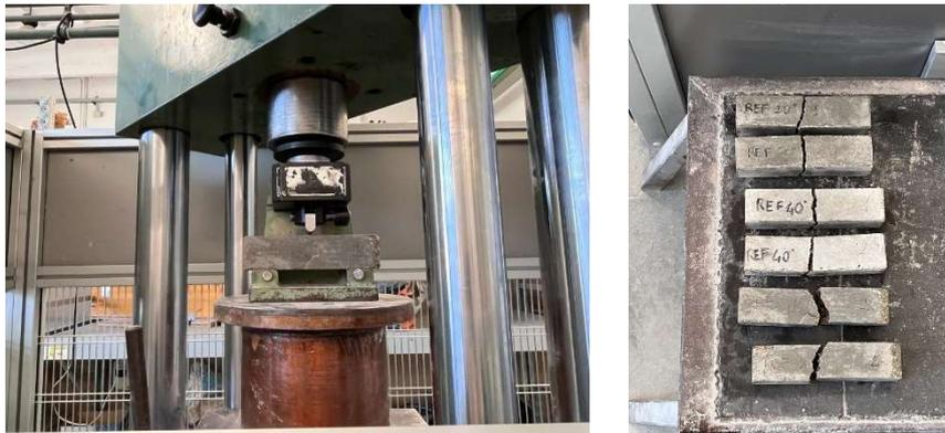
**Fig.4.17** – (a) Apparecchiatura per rottura a flessione; (b) Rottura a flessione dei provini.
