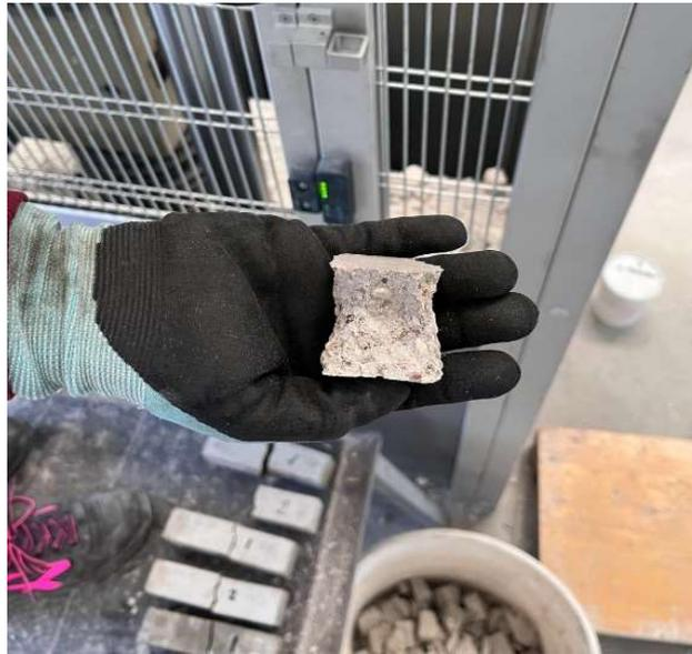
**Fig. 4.24** – Rottura a clessidra dei provini alla prova di resistenza meccanica a compressione.
