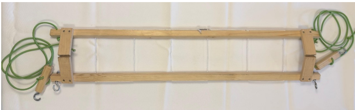
Fig. 19. Reticolo di campionamento realizzato artigianalmente in conformità alle dimensioni prescritte dal manuale ANPA (10 x 50 cm, suddiviso in cinque quadrati 10 x 10 cm), dotato di cerniere centrali per l'adattamento alla curvatura del tronco e di corda elastica con occhiello metallico per il fissaggio.
