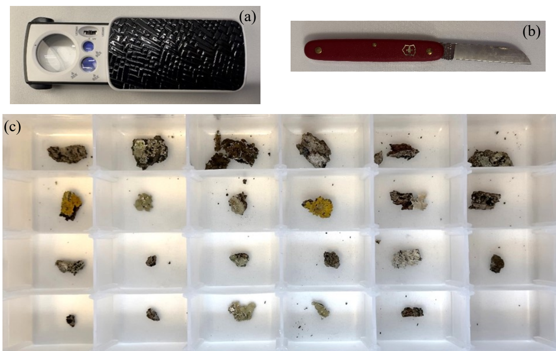
Fig. 22. Strumentazione ottica e di raccolta utilizzata in campo: (a) lente di ingrandimento multipla (30x - 60x - 90x) con illuminatore, (b) coltello a lama sottile e (c) contenitori per il prelievo di porzioni di corteccia colonizzata
