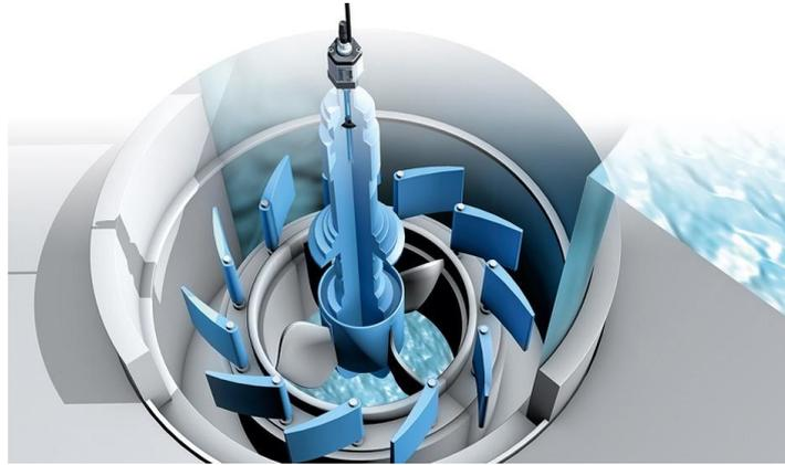
Figura 21: Visone palette statore e rotore [18]
