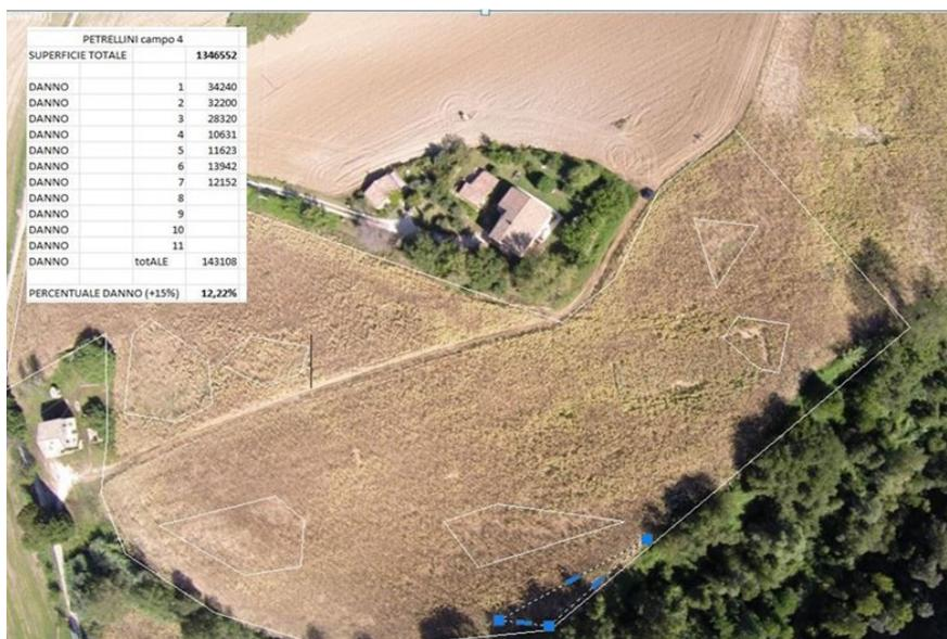
**Figura 4-5: Rilievo con drone ed elaborazione al CAD**
