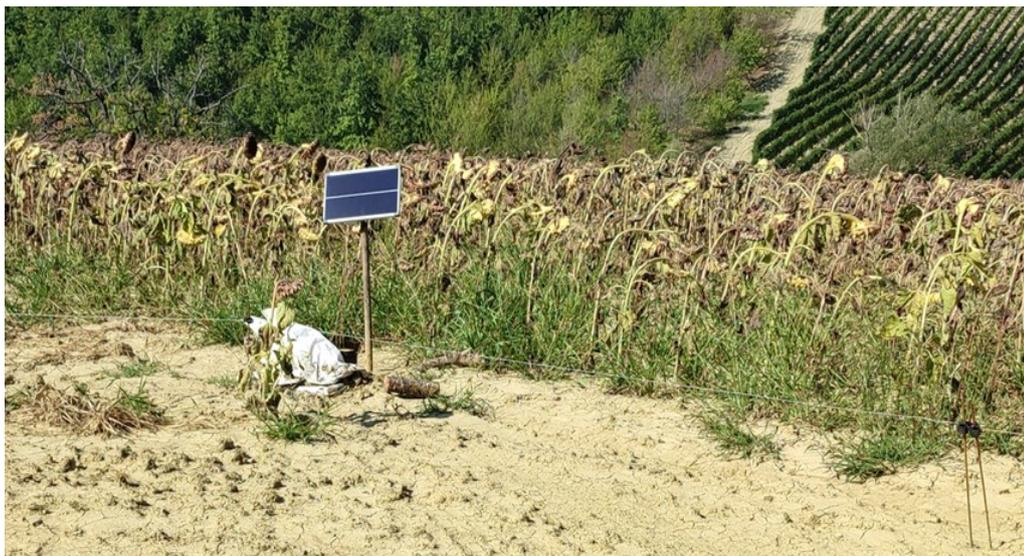
***Figura 6-4: Recinzione elettrificata ad un filo con elettrificatore (protetto dalle intemperie) e pannello fotovoltaico***
