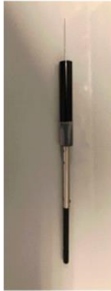
Fig.6 fibra a tripla fase divinilbenzene(DVB)/carboxen(CAR)/ polidimetilsilossano(PDMS)
