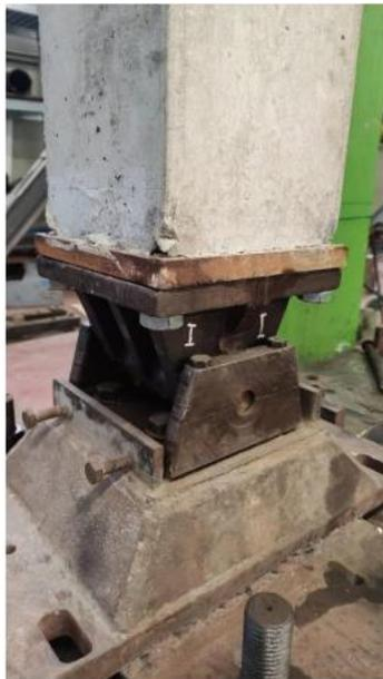
Figura 1.26 – Cerniera a terra alla base del pilastro
