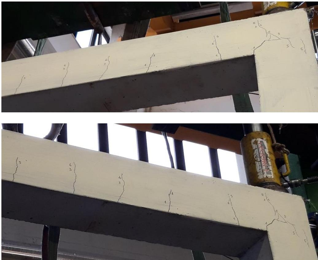
Figura 1.28 - Fessurazione del nodo in c.a
