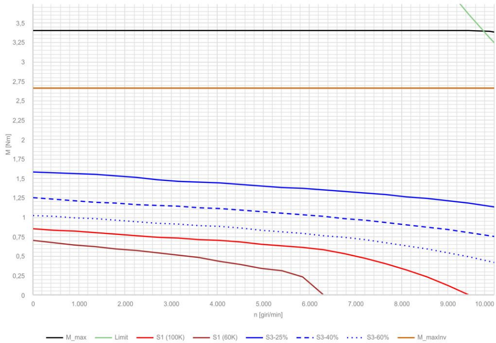
Figura 3.24: Curva caratteristica del motore selezionato.
