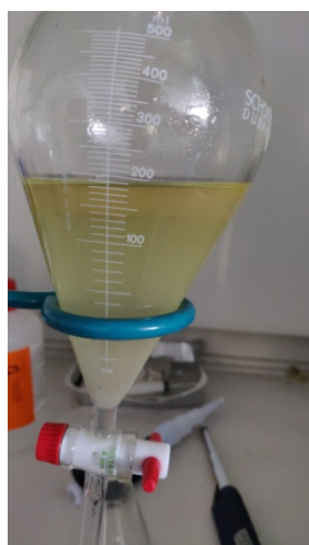
Figura 14 e 15 – 1° e 2° separazione liquido/liquido con imbuto separatore
