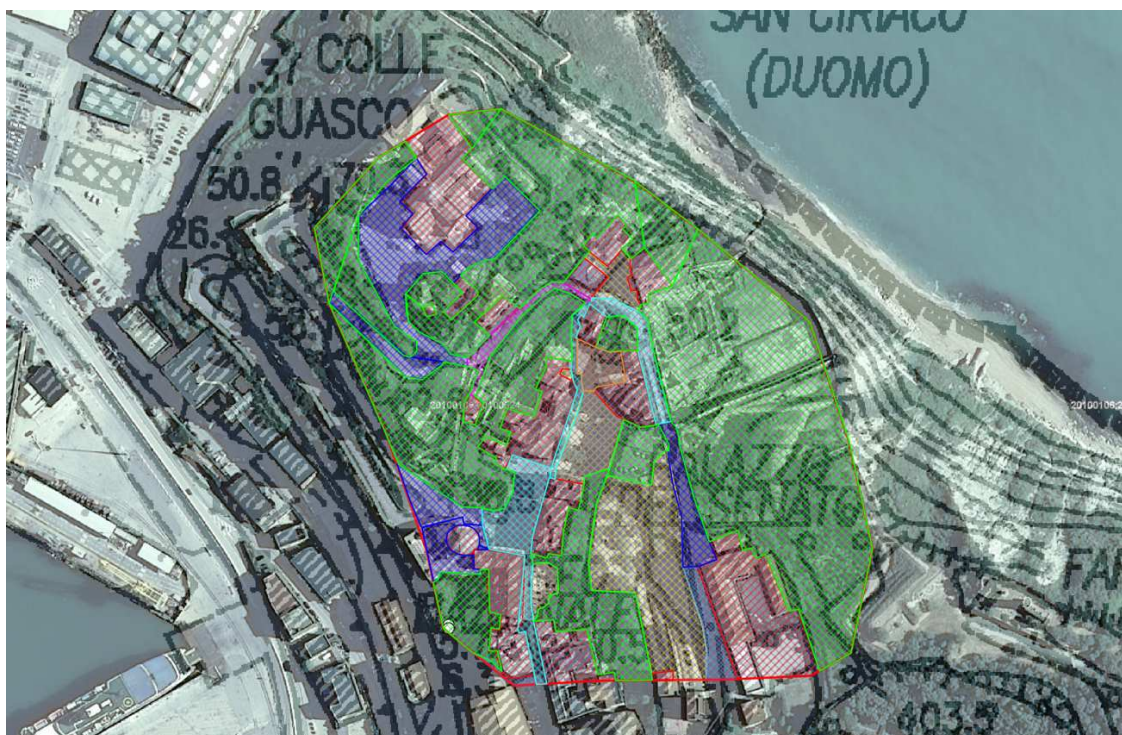
Fig. 2.4.4.5 – Distribuzione delle tipologie di superfici sull'area di alimentazione del bacino ipotizzata. Verde: aree verdi; Rosso: edifici; Blu: asfalto; Giallo: ghiaia; Azzurro: pavimentazione; Ciano: pavimentazione 2; Fucsia: pavimentazione 3; Arancione: pavimentazione 4
