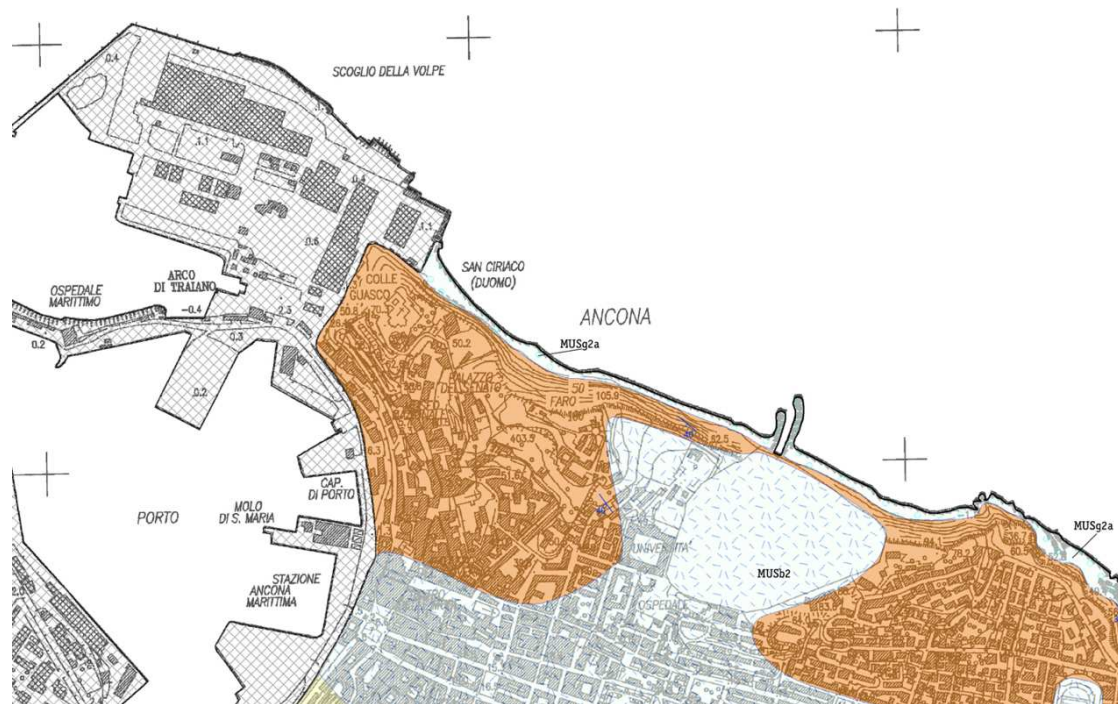
Fig. 2.4.1.6 – Carta geologica regionale sezione 282150, si evidenzia come la formazione dello Schlier (in arancione) sia inclinata di 40° in direzione sud-ovest verso il porto di Ancona (Regione Marche) 75
