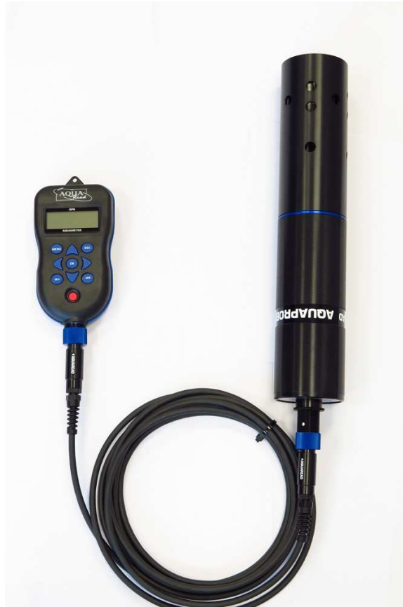
Fig. 2.2.1.2 – Sonda multiparametrica AP-7000, utilizzata in combinazione con GPS AquaMeter ( www.egeolab.it/sonde-multiparametriche-aquaread/gps-aquameter/amp )
