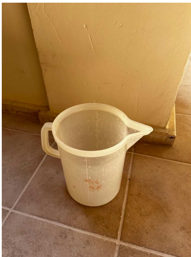
Fig. 2.3.11 – Contenitore graduato (5 litri) in plastica, per la misurazione delle portate
