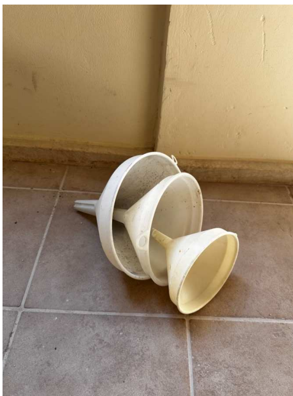
Fig. 2.3.13 – Set di imbuti di diversa grandezza, utilizzati per il convogliamento delle portate nei punti della sorgente dove è stato più difficile prelevare acqua con i soli contenitori e cilindri graduati.
