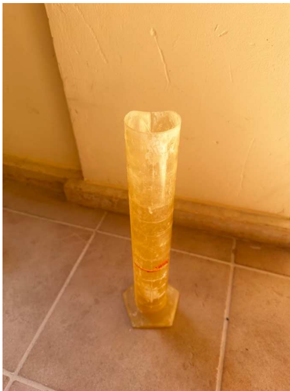
Fig.2.3.12 – Cilindro graduato (500 ml) in plastica, per la misurazione delle portate
