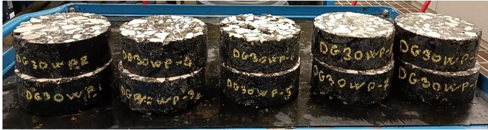
Fig. 3.17 – Provini altezza imposta 160 mm dopo del taglio
