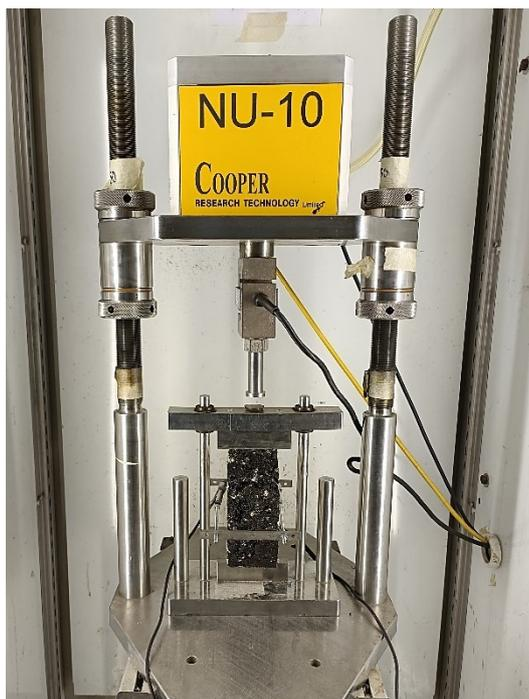
Fig. 3.34 – Provino all'interno della camera climatica del NAT
