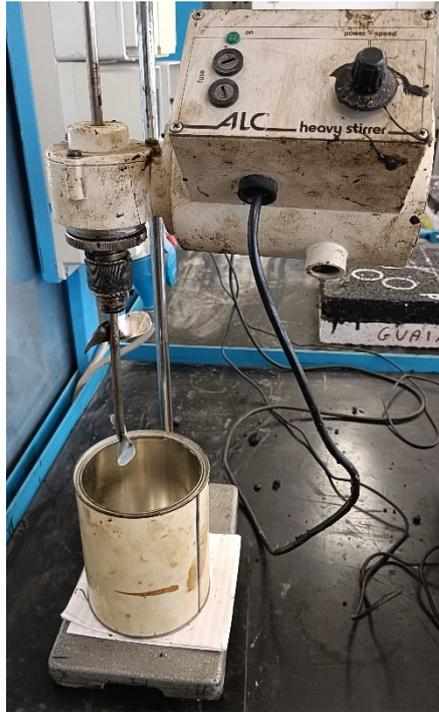
*Fig. 3.6 – Miscelatore per additivare il bitume*
