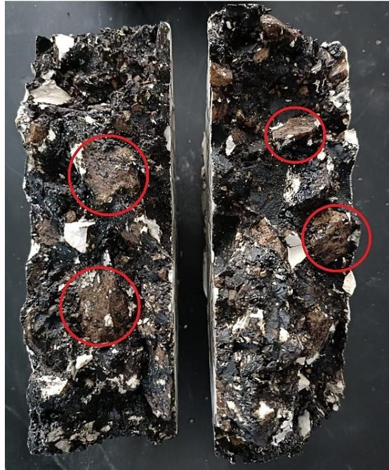
Fig. 4.19 – Provino DG\_HV\_130\_0.5\_2 rotto a fatica (ITFT) – cerchiati in rosso gli aggregati carenti di bitume
