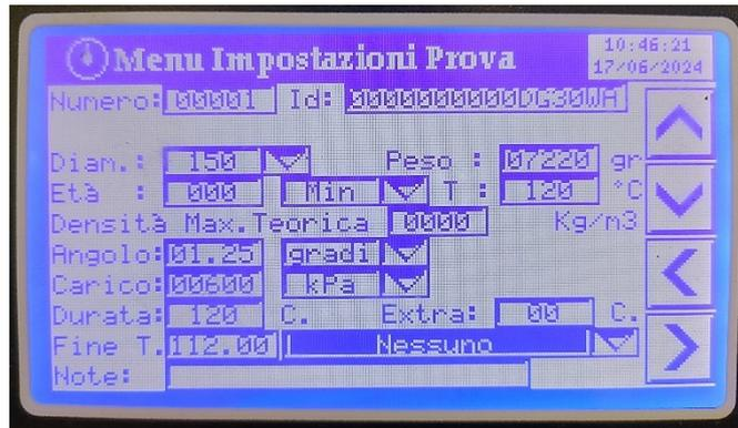
*Fig. 3.10 – Configurazione pressa giratoria a giri imposti*
