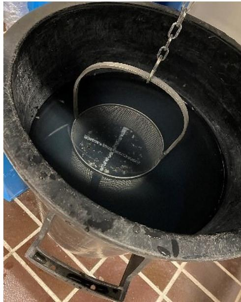
*Fig. 3.19 – Misurazione della massa in acqua  $m_2$*
