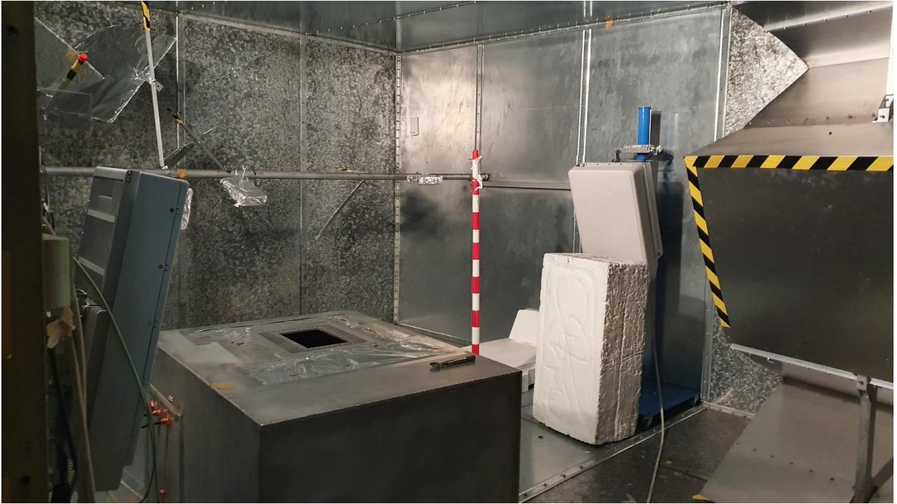
Figura 3. Foto dell'interno della camera riverberante
