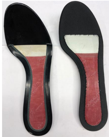
Figura 3.8 Fasciatura e scarnitura di solette di montaggio
