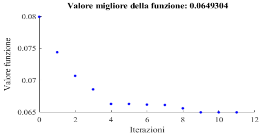
Figura 3.6-Andamento funzione di errore utilizzando il PSO
