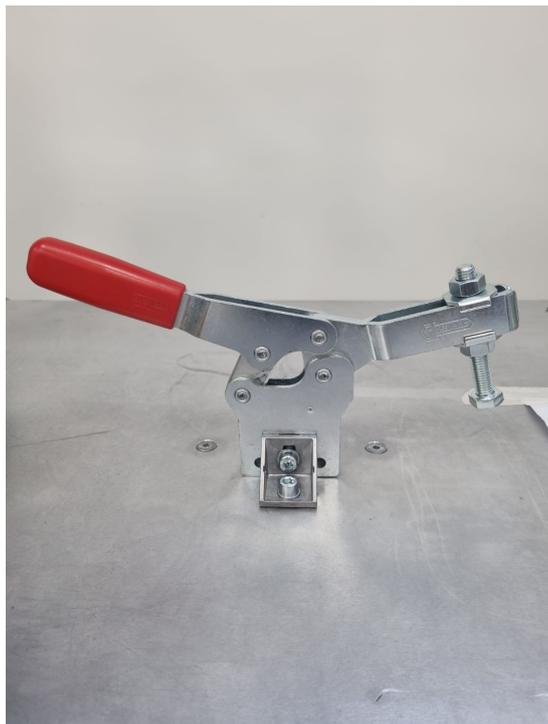
Figure 35: Attrezzo di bloccaggio orizzontale
