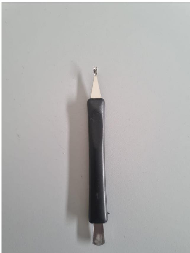
Figure 9: Utensile per rimozione bave
