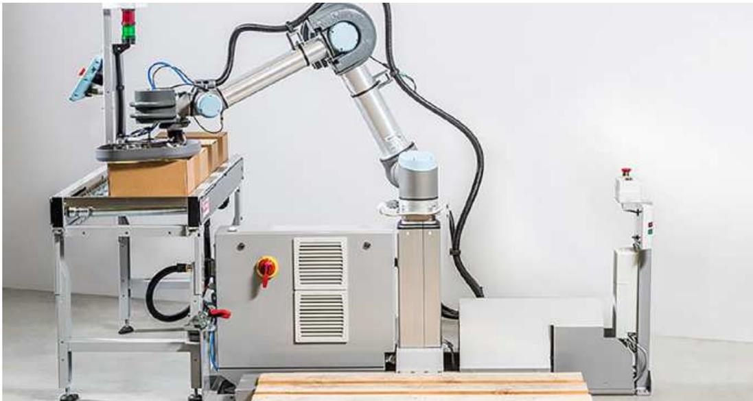
Figure 4: Illustrazione del braccio robotico con limitazione di potenza e forza (PFL) utilizzato in un sistema robotico collaborativo
