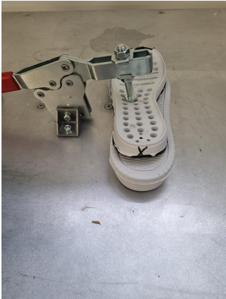
Figure 36: Assetto suola ferma
