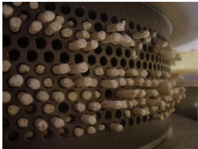
Figura 1- Dettaglio della trafilatura per la produzione del pellet
