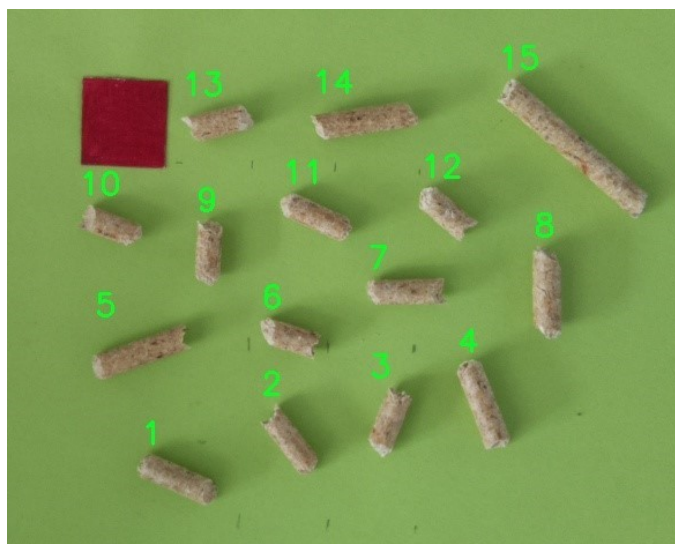
Figura 8 - Piano di acquisizione del PLD a seguito di una foto. Si osservi la presenza in alto a sinistra del quadrato di riferimento con dimensioni note
