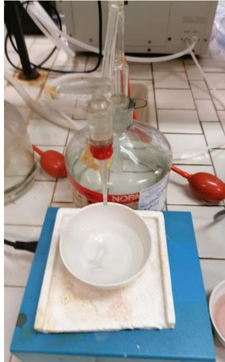
Fig 2.6.1 Il campione e l'ancoretta sono stati inseriti nella ciotolina e posti al di sotto della buretta
