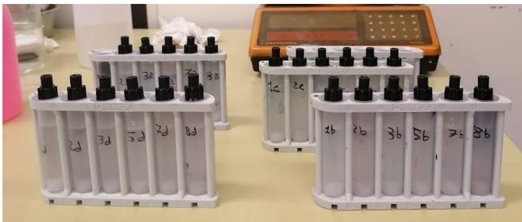
Fig 2.5.8 Vials comprese di tappo, inserite in portavials pronte per essere analizzate
