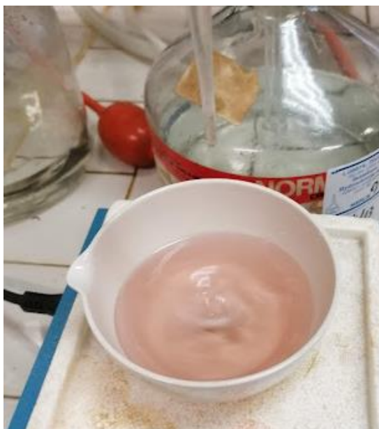
Fig 2.6.4 Al termine della titolazione la soluzione assume un colore rosato
