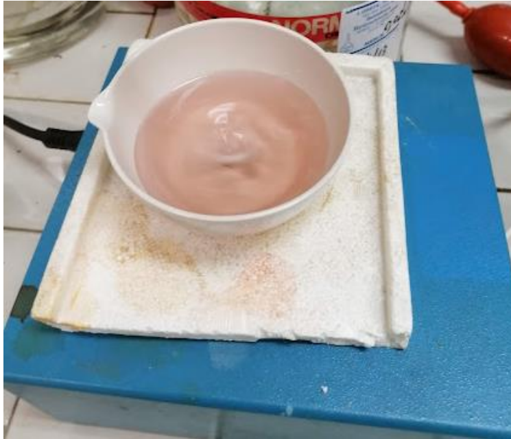
Fig 2.5.10 Agitatore magnetico in funzione, dove si nota anche la presenza dell'ancoretta
