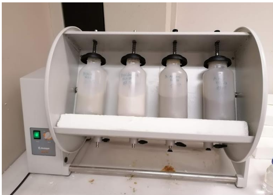
Fig 2.4.5 Immagine del tipo di agitatore con cui sono state svolte tutte le prove batch dinamiche
