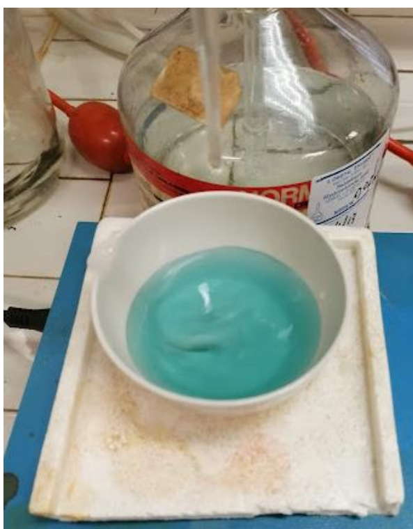
Fig 2.6.3 La soluzione assume questo colore a seguito dell'aggiunta dell'indicatore misto
