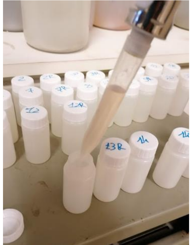
Fig. 2.4.4 Riempimento delle boccette da 20ml per conservare i campioni da analizzare
