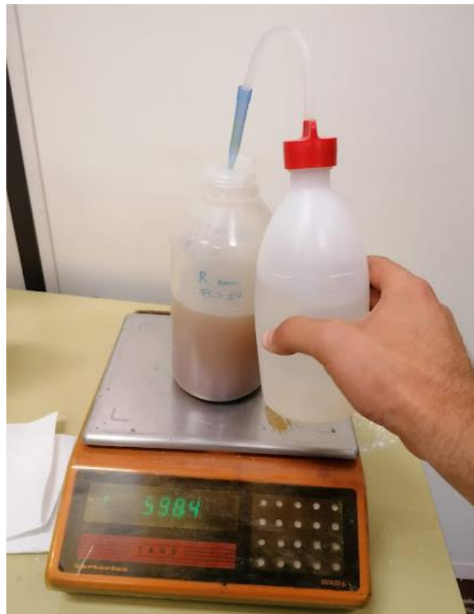
Fig 2.4.1 Istante dell'aggiunta di 600ml di acqua distillata
