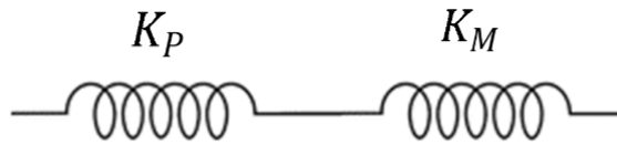
Figura 3.5: Modello di molle in serie
