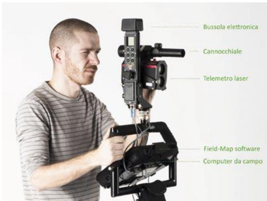
**Figura 2.7:** Il sistema Field-Map in configurazione completa (fonte: Zambarda et al. 2010)
