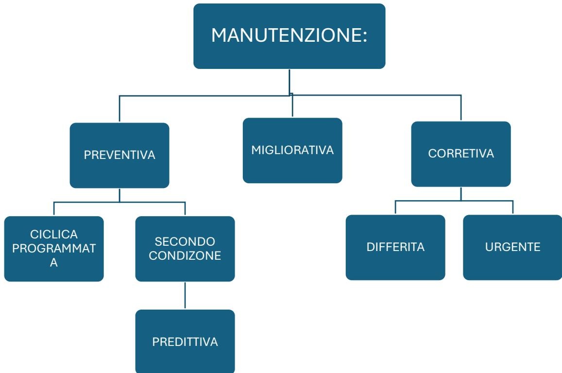
A loro volta questi tipi di manutenzione possono essere suddivisi in differenti tipologie e tecniche di manutenzione.
