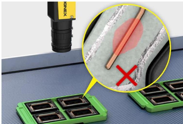
*Es: Ricerca di connettori allentati, fili mal saldati, cuciture difettose o tubi crimpati in modo improprio. (Immagine 2.16)*
