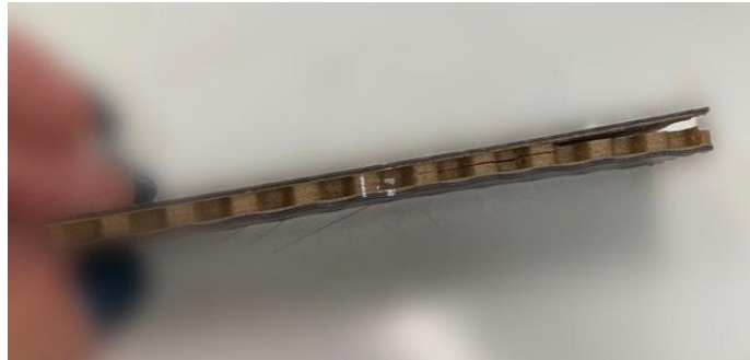
Figura [44] - Delaminazione dei provini sandwich ibridi e in Laywood
