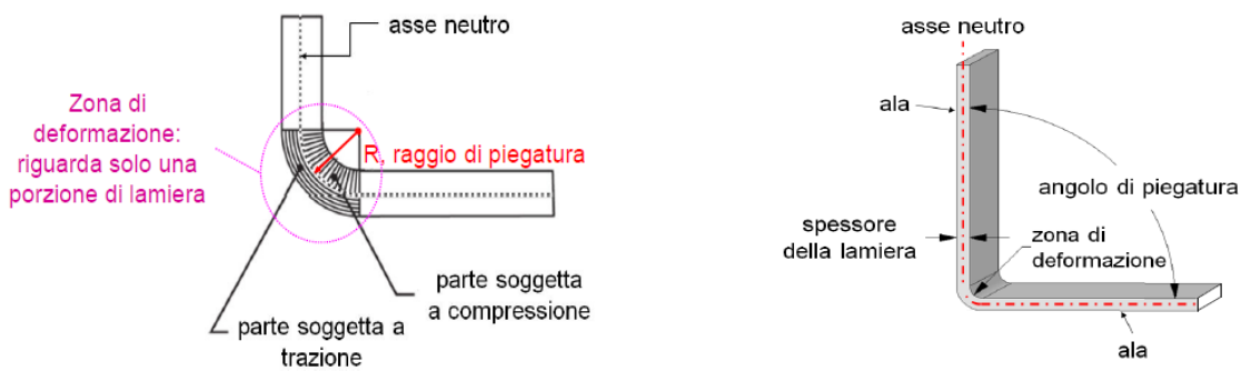
Figura [35] – Figura [36] – Descrizione piegatura con lamiera ferma
