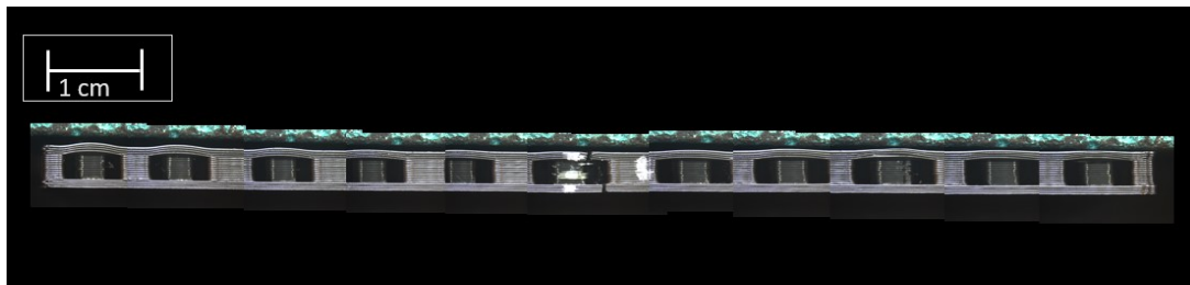
Figura [51] – Provino in PLA con polvere di grafene (ingrandimento 8x)
