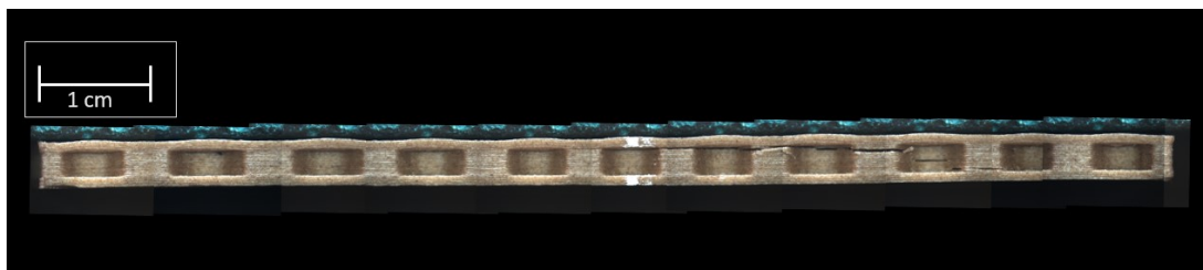
Figura [45] – Provino in PLA con legno balsa (ingrandimento 8x)
