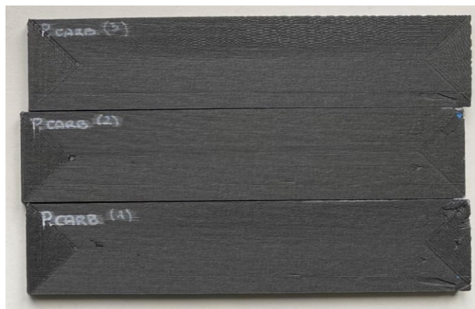
Figura [25] – Provini sandwich realizzati in PLA con fibre di carbonio
