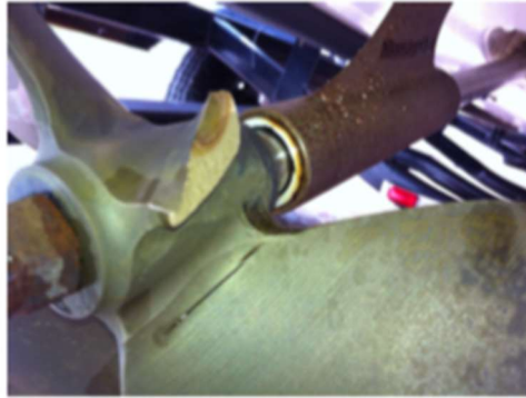
Fig 2.2.a - superficie di rottura per la fatica di una pala dell'elica di un'imbarcazione.[1]
