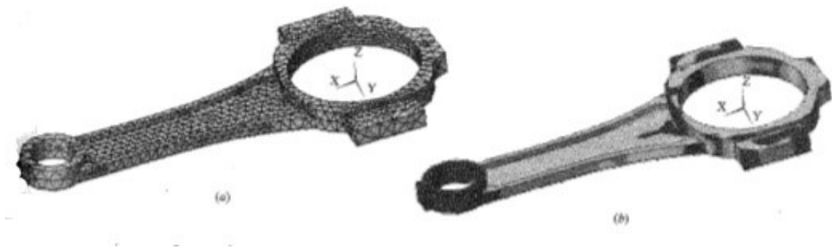
Fig 3.1.a – Modello di biella ottenuto con il software Ansys(a) mesh del modello; (b) curve di isolivello di tensione.[4]
