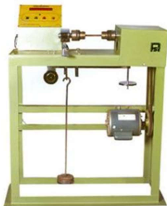
Fig 2.7.1.a - Macchina di R.R Moore per prove di flessione rotante.[1]
