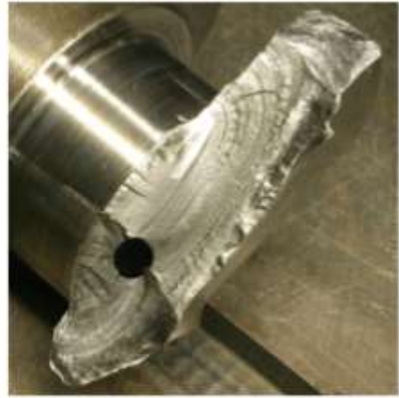
Fig 2.2.2.c - Linee di spiaggia sulla superficie di propagazione della cricca.[1]
