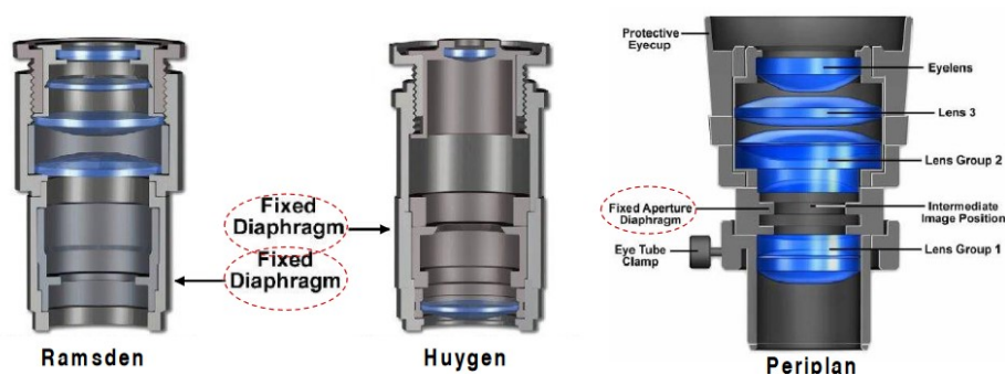
Figura 3.7 Rappresentazione e struttura delle diverse tipologie di oculare
