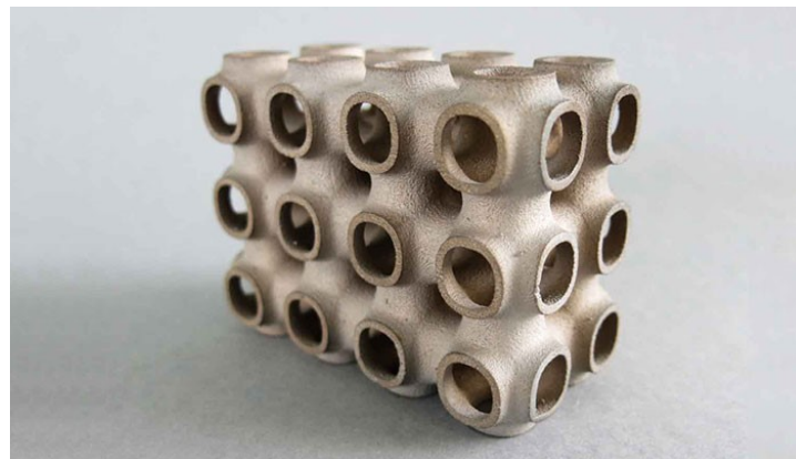
Figura 1.1 Pezzo realizzato tramite binder jetting
