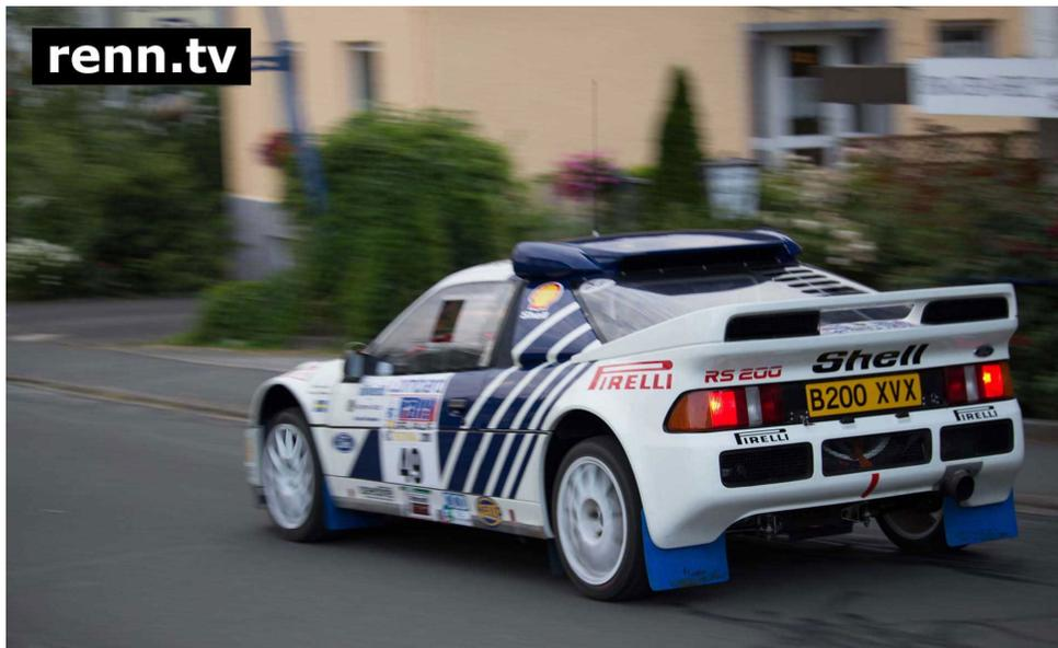
La **Ford RS 200**, che debutta nella categoria B un po' tardi rispetto le altre auto elencate, spinta da un motore turbocompresso di 1.780cm<sup>3</sup> capace di erogare 500 CV grazie alla trazione integrale.
