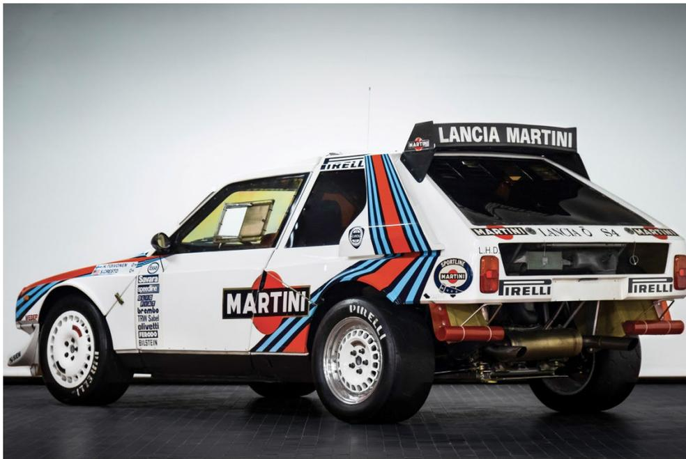
Infine, non perché di minore rilevanza, anzi, anche in casa Lancia decisero che era giunto il momento di passare alla trazione integrale, per opporsi alla titolata Audi Quattro, dando vita alla **Lancia Delta S4**, 4 come le ruote motrici e S per la sovralimentazione.
