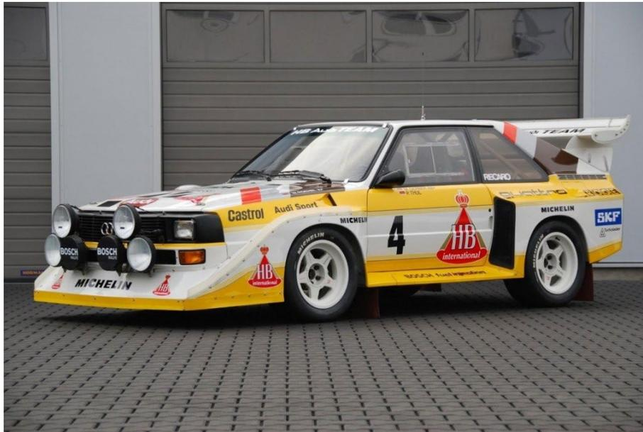
L'**Audi Quattro Sport S1**, colei che succede alla **Audi Quattro Sport**, prima auto da rally con trazione integrale permanente, dotata di un 5 cilindri turbo da 2.133cm<sup>3</sup> montato in posizione anteriore longitudinale capace di produrre fino a 450 CV.
