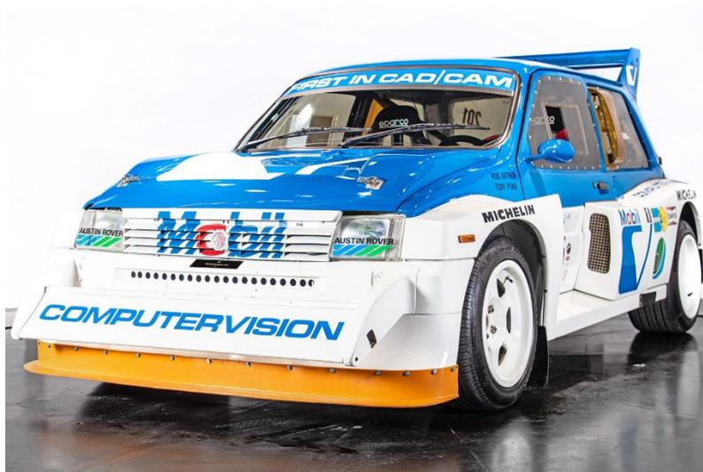
L'**Austin Metro 6R4**, unica vettura del Gruppo B a montare un motore V6 da 3.000cm<sup>3</sup> aspirato in posizione centrale longitudinale. Potenza massima erogata di circa 410 CV attorno ai 9.000 giri/minuto sprigionabile su tutte e quattro le ruote. Il suo problema era la perdita di potenza ai bassi regimi, essendo un motore aspirato.
