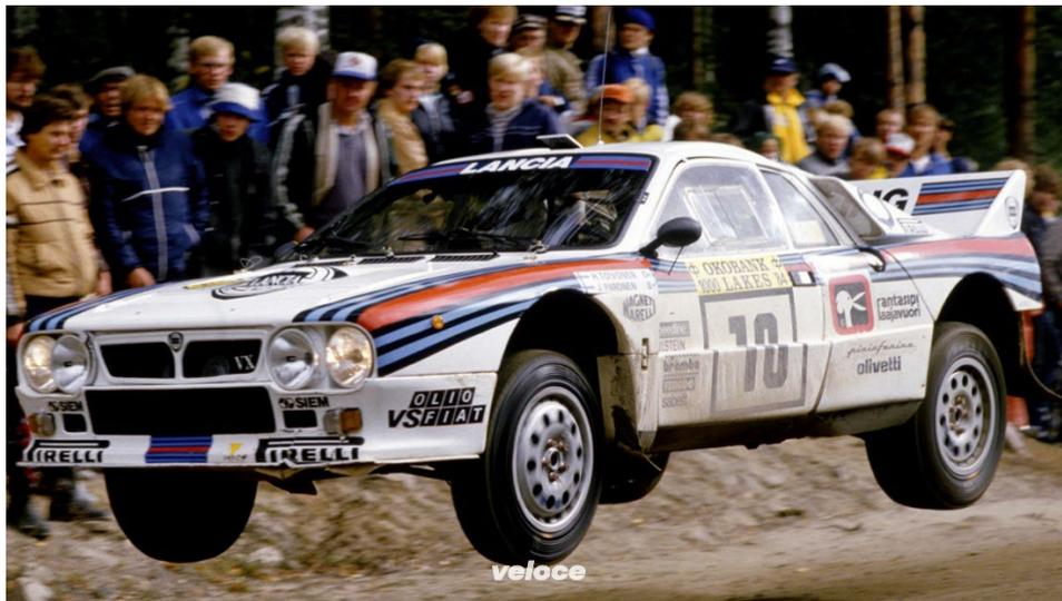
La **Lancia Rally 037**, motore 4 cilindri in posizione centrale di cilindrata pari a  $2.000\text{cm}^3$  sovralimentato con compressore volumetrico capace di erogare 325 CV sulle ruote posteriori.
