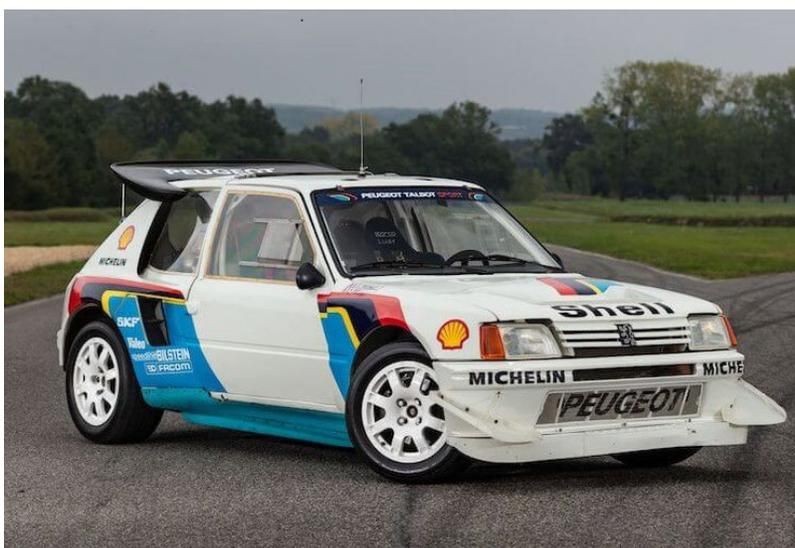
La **Peugeot 205 Turbo 16**, dotata di motore 4 cilindri in linea di 1.775cm<sup>3</sup> sovralimentata da un turbocompressore in grado di sviluppare 350 CV. Propulsore in posizione centrale trasversale e trazione integrale permanente.
