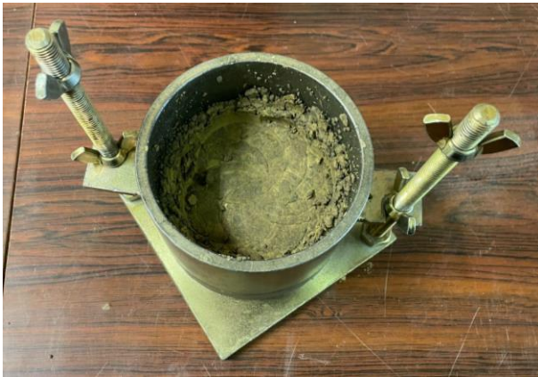
Figura 12 - Terreno dopo la compattazione con il pestello nella prova Proctor
