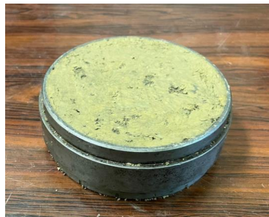
Figura 13 - Campione ottenuto dalla prova Proctor con la fustella
