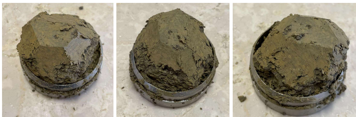
Figura 50 - Terreno SGT additivato con 4% fly ash e stagionato 28 giorni, stato del provino prima del completamento del trimming da diverse angolazioni
