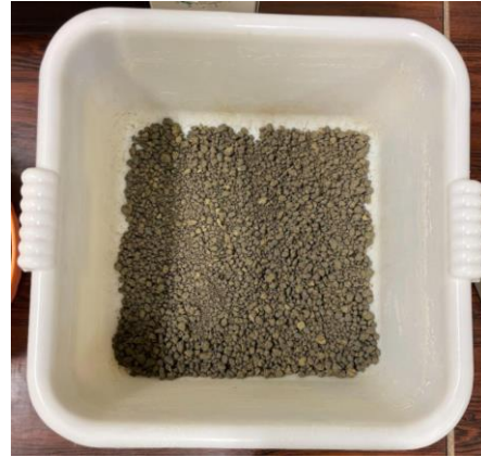
Figura 15 - Terreno della prova Proctor con umidità del 20% ed additivato con fly ash
