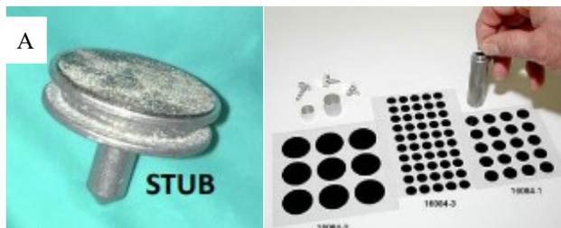
**Figura 3.13** Stub [35]      **Figura 3.14** adesivo per stub [35]
