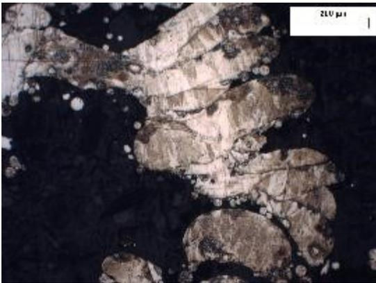
**Figura 3.9** microstruttura parte esterna scaffold con ingrandimento 10x1
