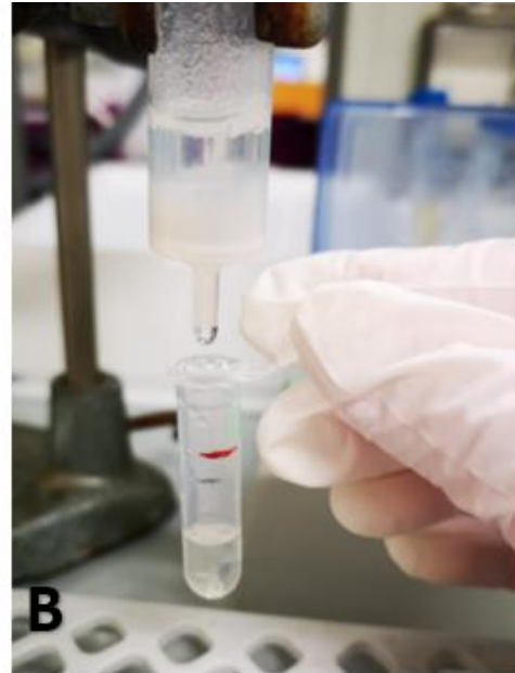
Figura 15. (A) Nickel Chelating Resin (GBiosciences), resina utilizzata per la cromatografia di affinità, presenta una capacità di legare in 1ml 50mg di proteina con il His-tag; (B) La raccolta dei campioni: Il contenuto scende per gravità e la resina di impacchetta sul fondo della colonna dove sarà presente un filtro, ciò che passa viene detto flowthrough (FT). In seguito, si effettuano diversi lavaggi e in fine l'eluizione. Concluso il processo di purificazione, la resina verrà rigenerata e mantenuta in etanolo al 20% per evitare la disidratazione.
