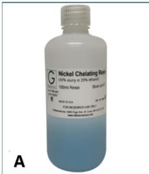
Figura 15. (A) Nickel Chelating Resin (GBiosciences), resina utilizzata per la cromatografia di affinità, presenta una capacità di legare in 1ml 50mg di proteina con il His-tag; (B) La raccolta dei campioni: Il contenuto scende per gravità e la resina di impacchetta sul fondo della colonna dove sarà presente un filtro, ciò che passa viene detto flowthrough (FT). In seguito, si effettuano diversi lavaggi e in fine l'eluizione. Concluso il processo di purificazione, la resina verrà rigenerata e mantenuta in etanolo al 20% per evitare la disidratazione.
