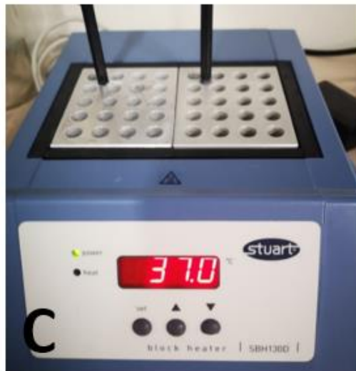
Figura 12. Incubatore Shel Lab (A), Piastra con colonie replicate su piastre master (B), (C)Thermoblock usato per lo shock termico.
