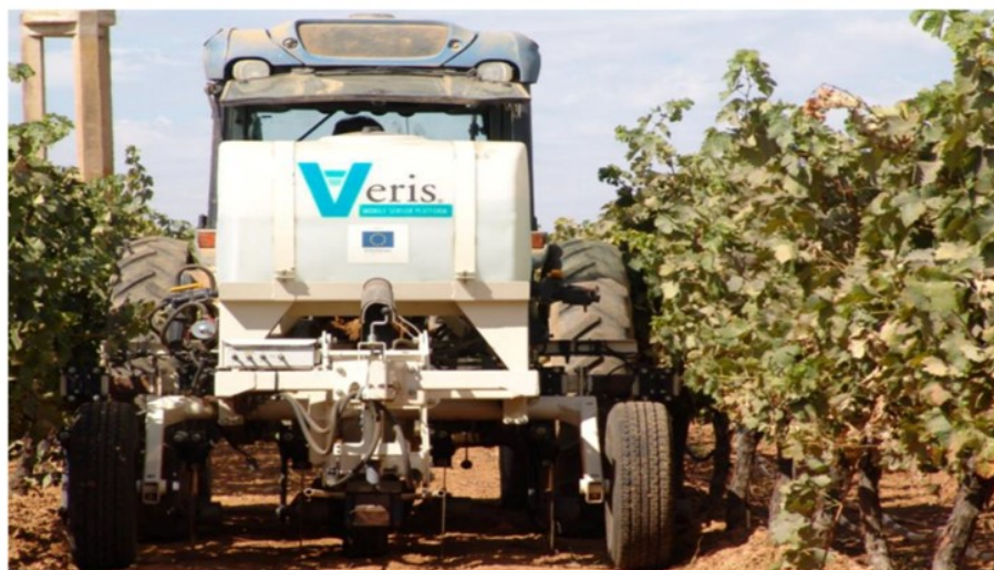
Figura 4-2 Piattaforma mobile con sensori in grado di misurare la conducibilità elettrica (fonte: State of the Art of Monitoring Technologies and Data Processing for Precision Viticulture, M. Ammoniaci, S. Kartsiotis, 2021)
