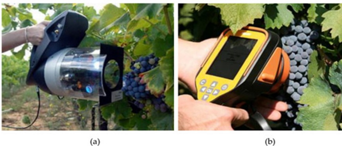
Figura 4-6 Strumenti di precisione per il monitoraggio della qualità (a) Multiplex, (b) Spectron (fonte: State of the Art of Monitoring Technologies and Data Processing for Precision Viticulture , M. Ammoniaci, S. Kartsiotis, 2021)
