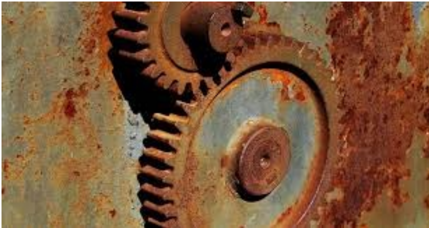
Fig 3.1 corrosione su una coppia di ingranaggi
