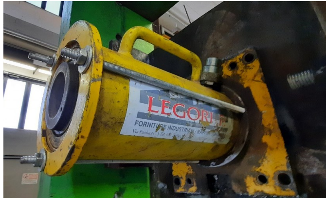
Fig.28 – Martinetto idraulico Enerpac
