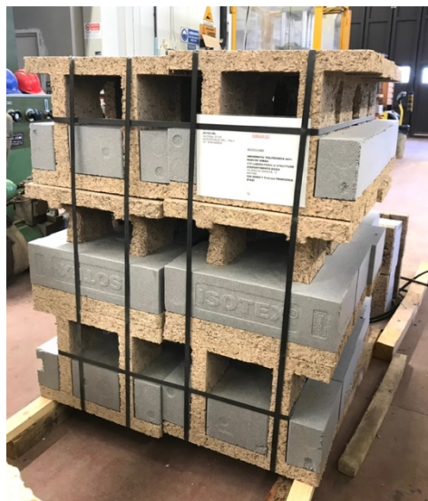
Fig.7 - Blocco cassero HDIII 38/14 grafite utilizzato
