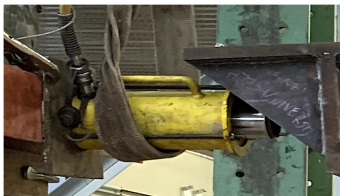
Fig.30 – Piastra utilizzata per distribuire il carico
