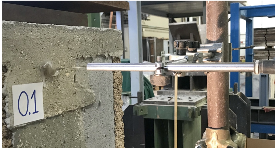
Fig.35 – Predisposizione del trasduttore O.1
