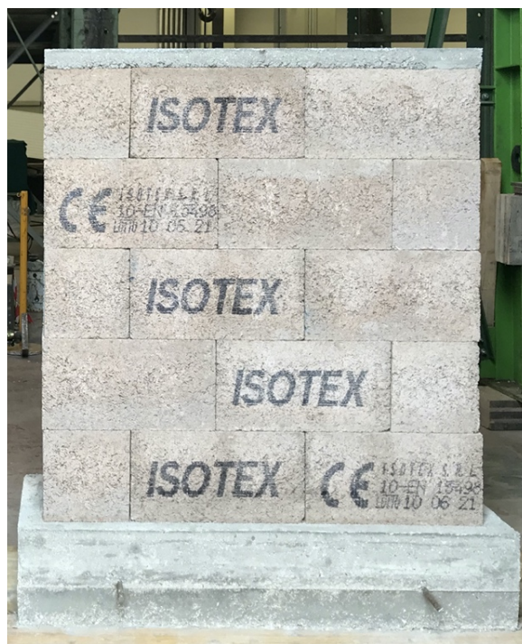
Fig.31 – Provino A1 dopo la costruzione in laboratorio
