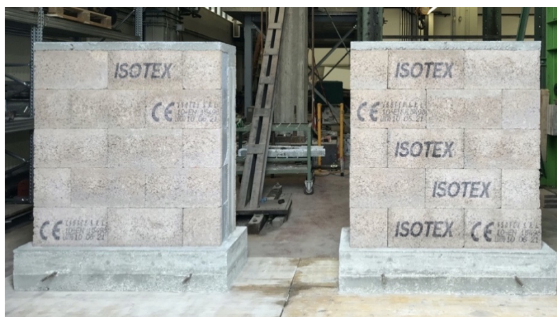
Fig.8 - Provini A1 e A2 utilizzati nei test
