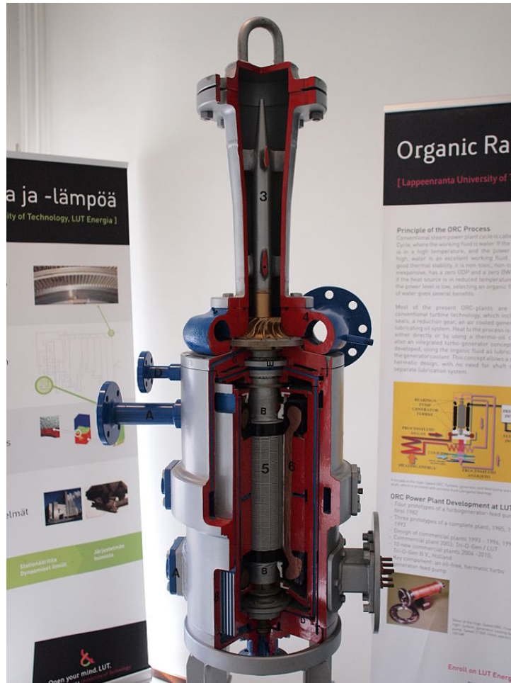
Figura 6: Impianto ORC da 75kW in Lappeenranta, Finlandia. Per l'immagine si faccia riferimento a [F5]
