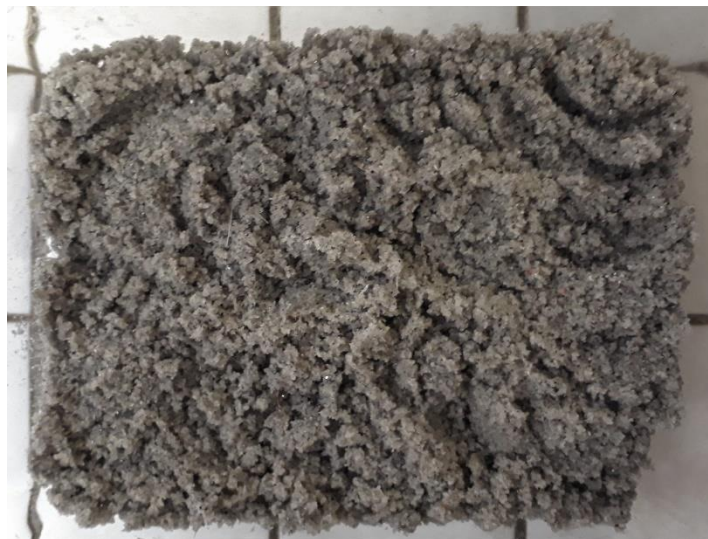
Figura 4 - LCD umido dopo lisciviazione e lavaggi
