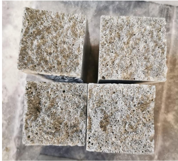
Figura 9 - Superficie di rottura a flessione
