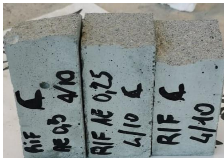
Figura 10 – Provini per rottura a compressione
