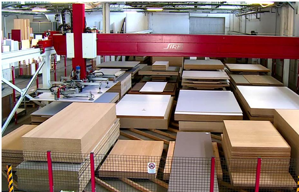
Figura 10.1: Esempio di un magazzino a terra servito da un trasloelevatore cartesiano.
