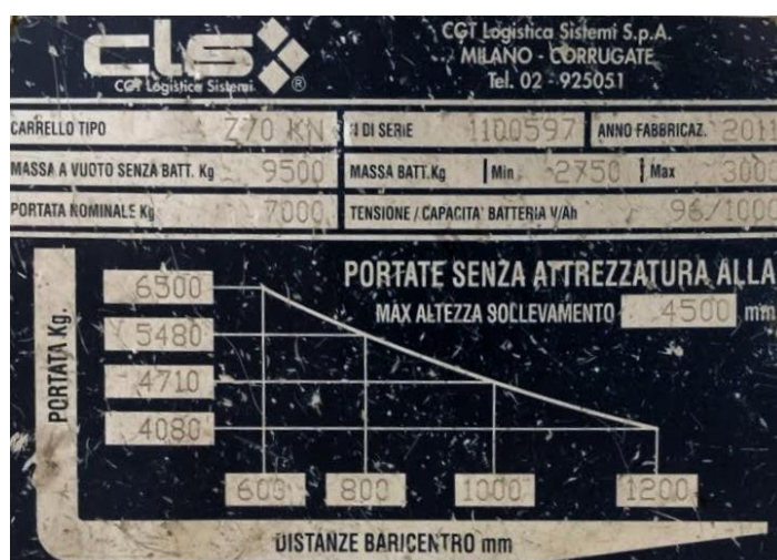
Figura 9.4: Targa del carrello riportante la portata in funzione del baricentro del carico.
