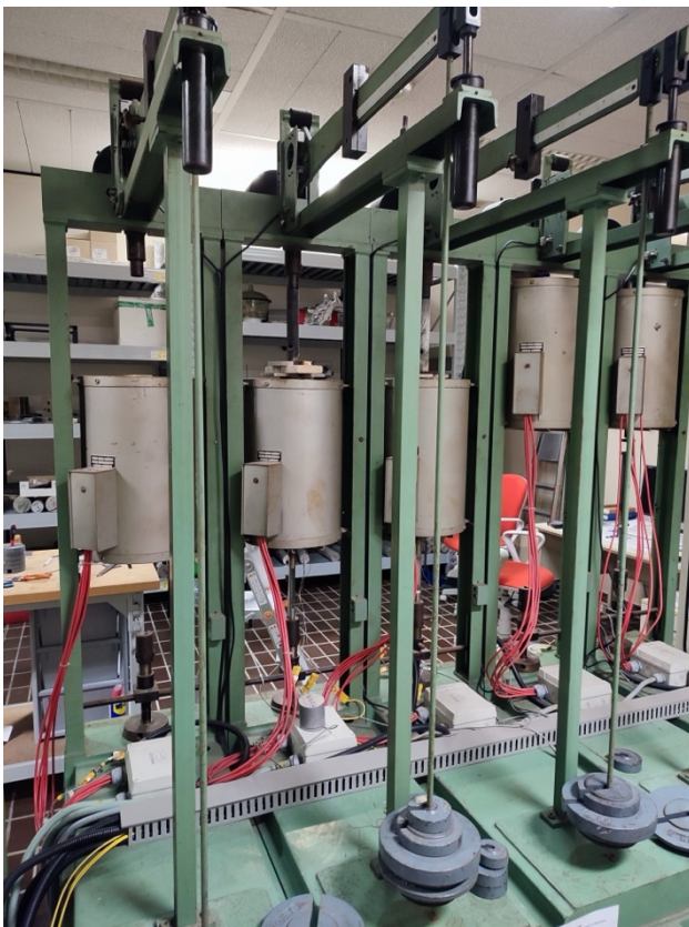
Figura 11. A destra, il macchinario per la prova di creep, i cilindri grigi sono forni elettrici. A sinistra è visibile il provino negli afferraggi, inoltre in dettaglio vengono evidenziate le termocoppie per la misurazione della temperatura.
