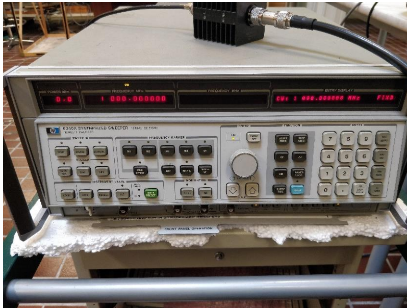
Figura 3.2 Generatore di segnale HP
