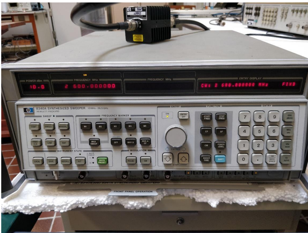
Figura 3.21 Generatore di segnale HP
