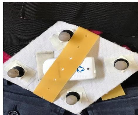
**Figura 17.** IMU su placca al centro di 4 marker passivi
