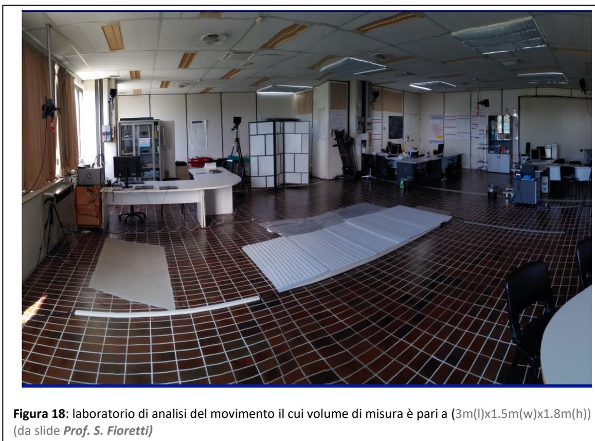
bilateralmente. Tale sistema è composto da 8 telecamere a infrarosso (TVC) di cui sei fissate a parete e due su cavalletti, più una telecamera per la registrazione di filmati posta su cavalletto a terra ad un estremo del walkway system.
